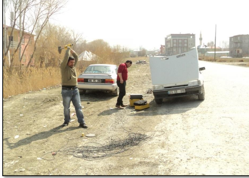
Şekil 4.12 Sismik kırılma çalışmalarından bir görünüm
