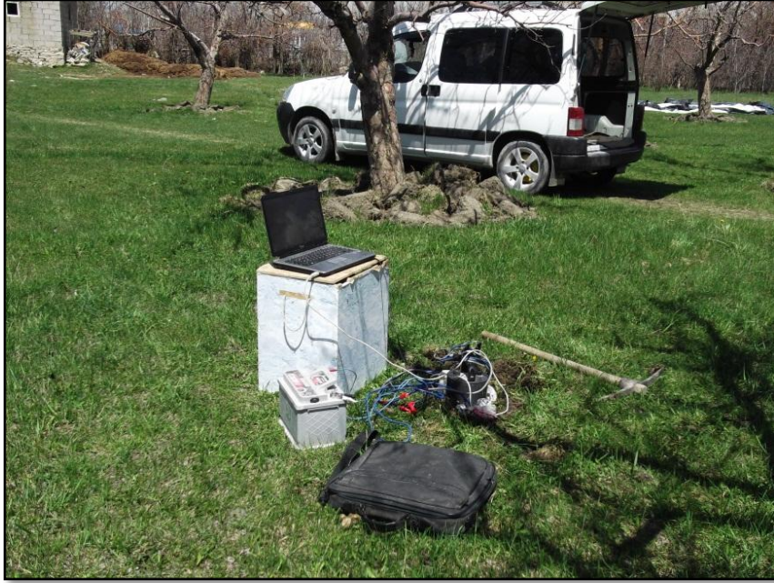
Şekil 4.12 İnceleme alanında alınan mikrotremör ölçüye ait görüntü
