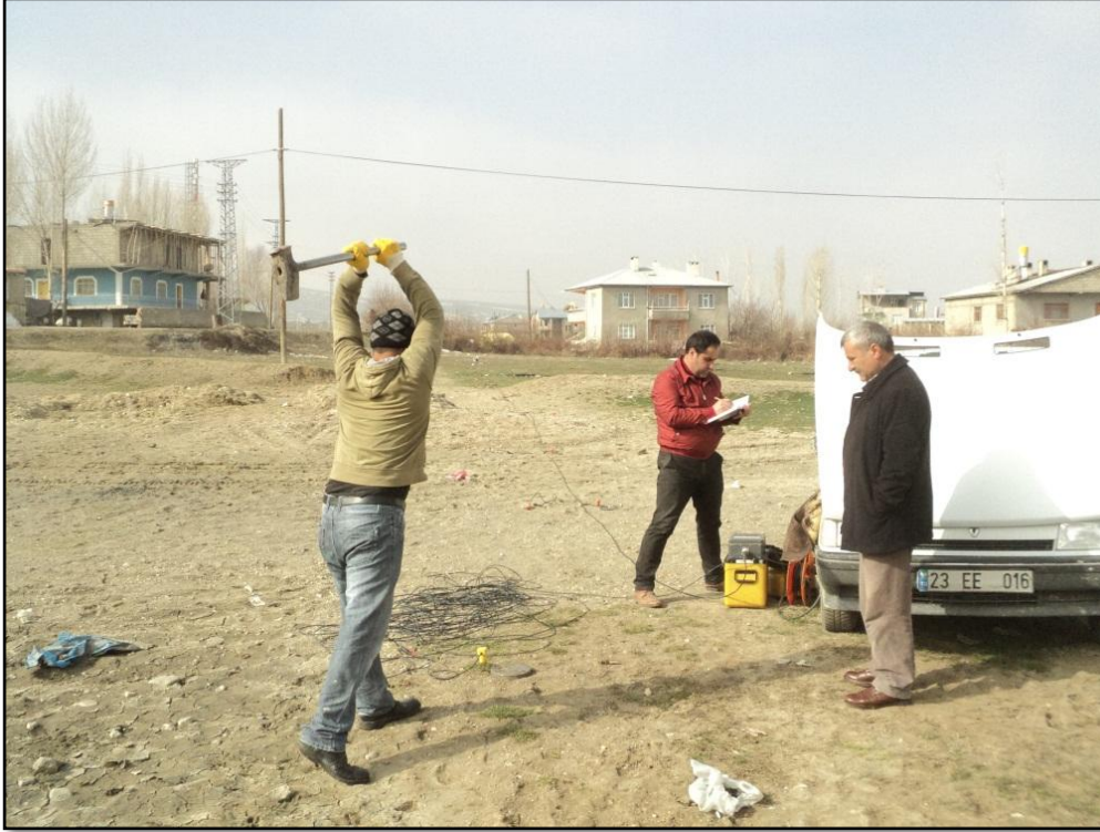
Şekil 4.13 Sismik yansıma çalışmalarından bir görünüm
