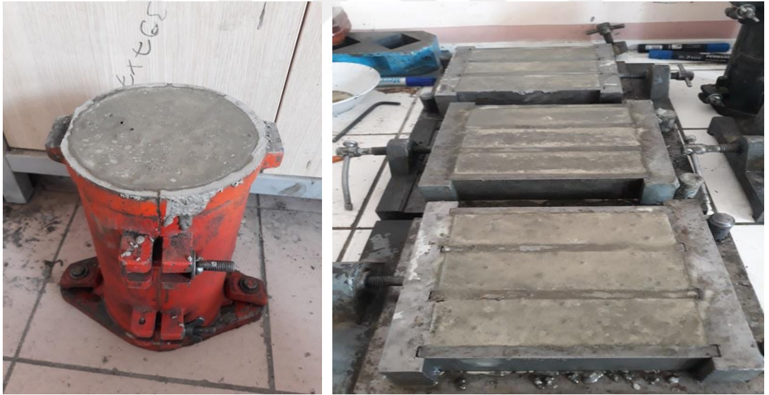
Fotoğraf 3.3. Silindir numunelerin (a) ve prizmatik numunelerin kalıplanmış hali (b)
