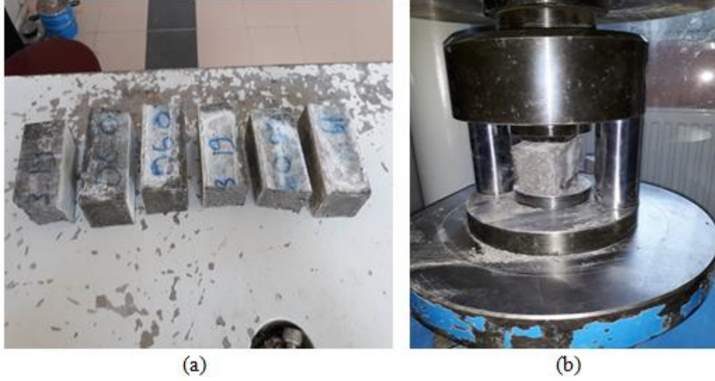
Fotoğraf 3.8. Eğilme deneyinden elde edilen 6 adet numune (a) ve numunenin basınç deneyi cihazına yerleştirilmiş hali (b)
