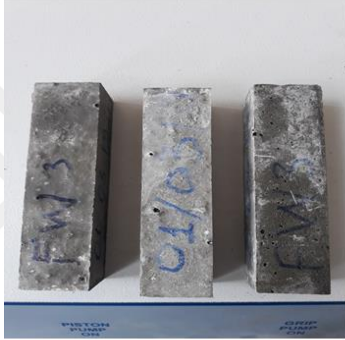
Fotoğraf 3.7. Sertleşmiş birim ağırlık tespitinde kullanılan prizmatik numuler
