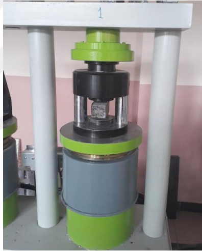
Fotoğraf 3.9. Geopolimer malzemelerde basınç dayanım deneyinin gerçekleştirilmesi
