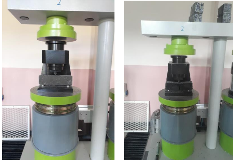
Fotoğraf 3.8. Geopolimer numunelerde eğilme deneyinin gerçekleştirilmesi
