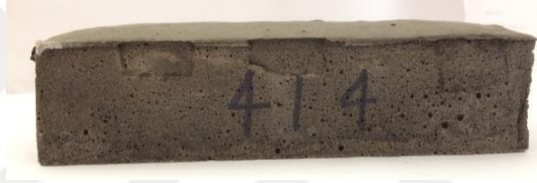
Fotoğraf 3.7. Üretilen geopolimer numunesi
