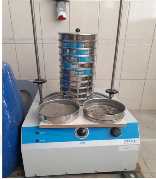
Fotoğraf 3.5. UKL'lere yapılan elek analizi
