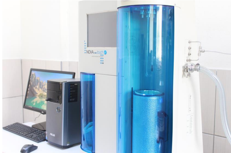
Fotoğraf 3.4. UKL'lerin yüzey alanı ölçümünün yapıldığı BET cihazı
