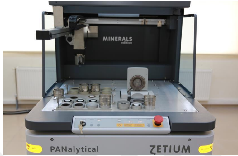
Fotoğraf 3.1. UKL'lerin kimyasal analizinde kullanılan XRF cihazı
