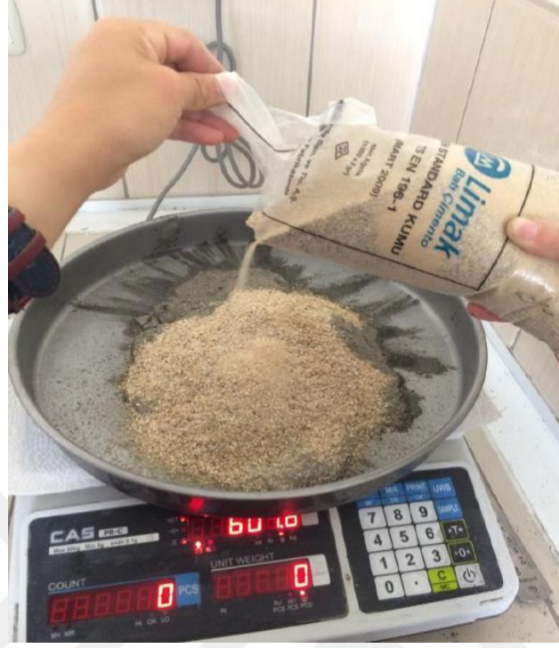
Fotoğraf 3.6. Rilem Cembureau standart kumunun deney için tartım aşaması
