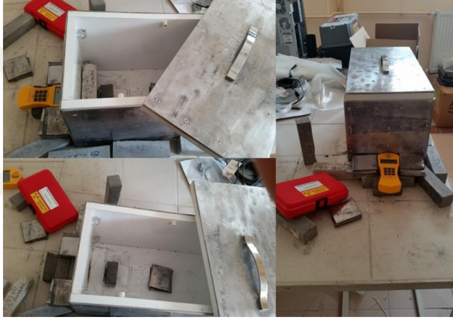
Fotoğraf 3.10. Tez çalışmasında üretilen geopolimer yapı malzemelerinin radyasyon sönümlenme durumunun belirlenmesi için tasarlanmış kurşun levha ile kaplanmış kafes, radyasyon kaynağı ve Geiger-Müller sayacı
