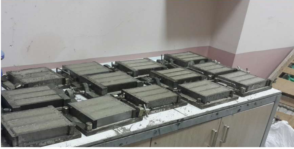
Fotoğraf 3.2. Taze beton numuneleri
