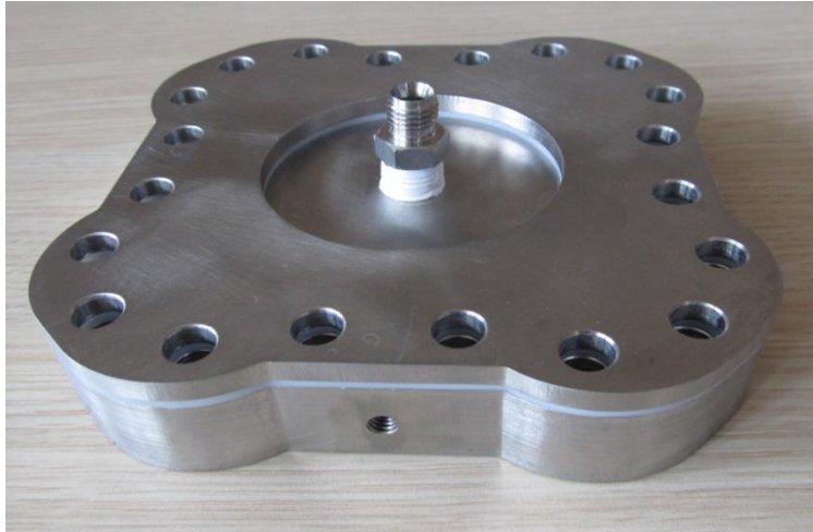
Fotoğraf 2.6 Sıkıştırma plakası, yalıtkan malzeme ve son plaka montaj hali
