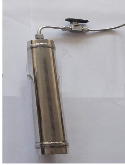
Fotoğraf 3.10 Hidrojen deposu ve bağlantı elemanları
