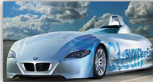
Fotoğraf 2.1 BMW firmasının yapılmış hidrojeni doğrudan yakarak kullanan otomobil
