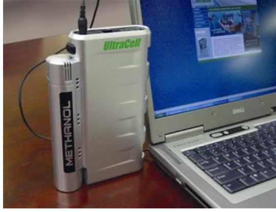
Fotoğraf 2.3 Ultracell firmasının geliřtirmiş olduđu harici güç kaynađı
