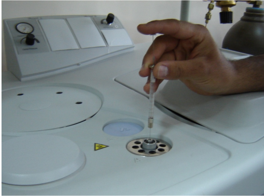
Fotoğraf 5.5 Gaz kromatografi cihazına ölçüm için numune enjekte edilmesi
