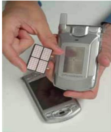
Fotoğraf 2.2 Hitachi'nin geliştirdiği prototip yakıt hücresi kartuşu
