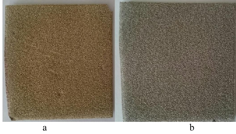
Fotoğraf 3.21. Altın kaplanmış gözenekli Ni (a) ve altın kaplanmamış gözenekli Ni (b)
