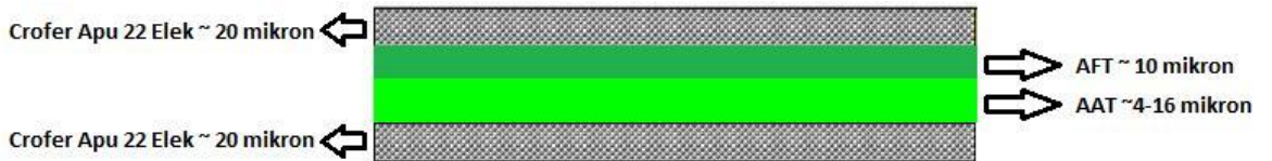
Şekil 3.3. Crofer 22 APU elek kullanılarak hazırlanan MDKOH
