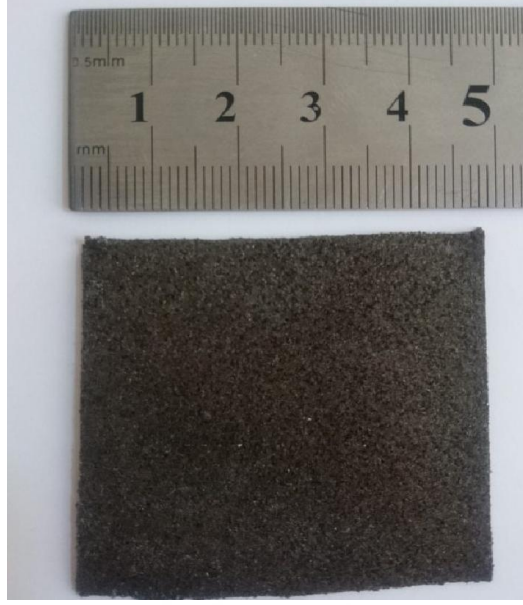
Fotoğraf 3.9. Preslenen Crofer 22 APU yapraklarının sinterlenmeden önceki hali
