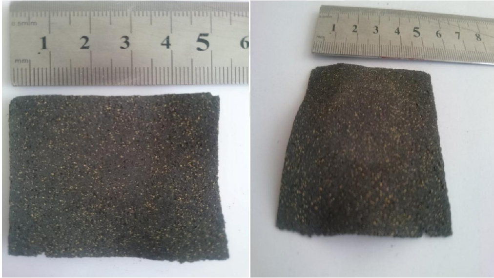
Fotoğraf 3.9. Preslenen Crofer 22 APU yapraklarının sinterlenmeden önceki hali
