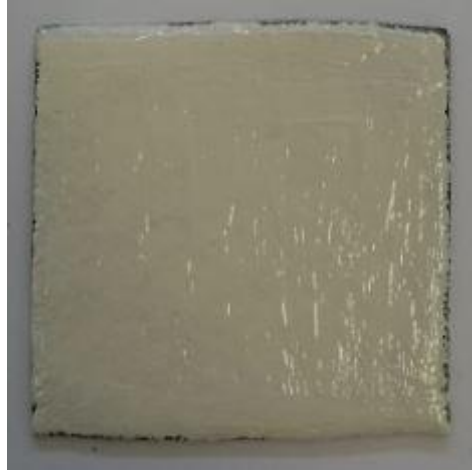
Fotoğraf 3.13. Sinterlenmiş MEG’i GDC elektrolit çamuruna boyama
