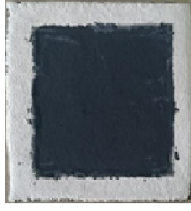
Fotoğraf 3.28. İpek baskı yöntemi kullanılarak NiO anot GDC elektrolit ve Ni-Li katot boyanan numune
