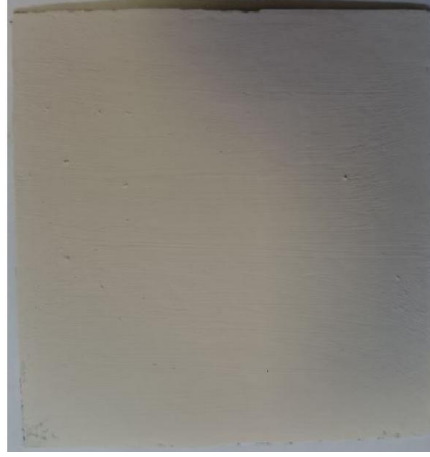
Fotoğraf 3.24. Sinterlendikten sonra GDC elektrolit boyama
