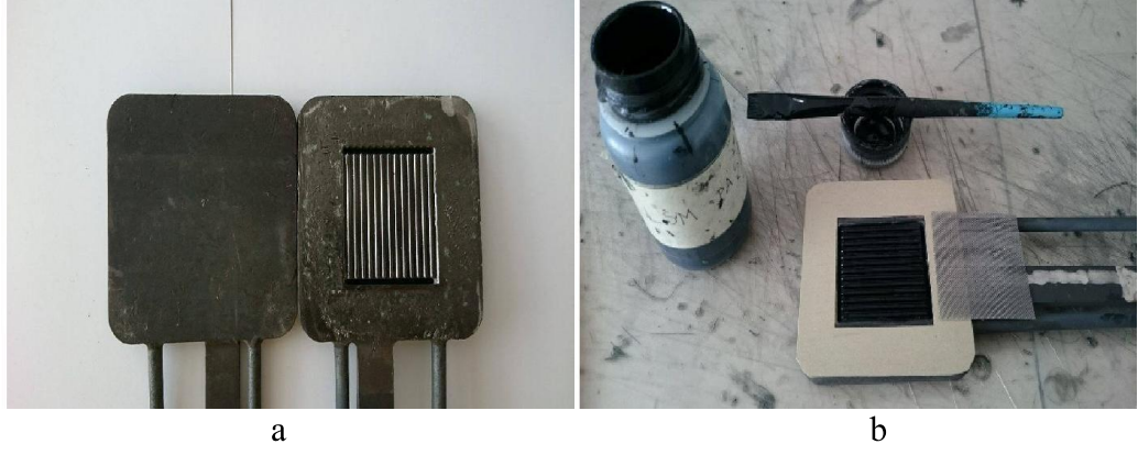
Fotoğraf 4.1. Crofer 22 APU interkonnektör çifti (a) ve deney hazırlanma aşaması (b)
