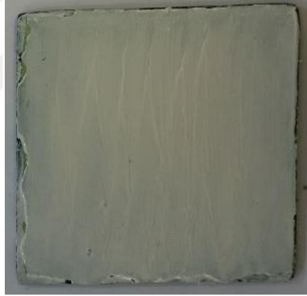
Fotoğraf 3.18. GDC elektrolit kaplanmış paslanmaz çelik 316L destek
