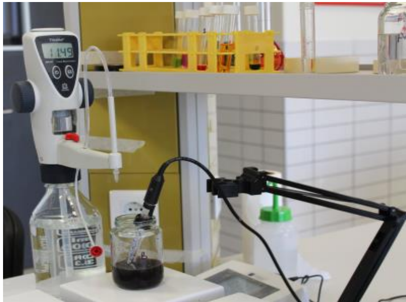
Fotoğraf 3.6. Titre edilebilir asit oranı ölçümü
