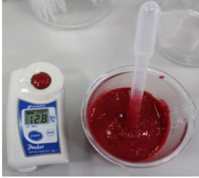
Fotoğraf 3.5. Dijital refraktometre ile SÇKM ölçümü
