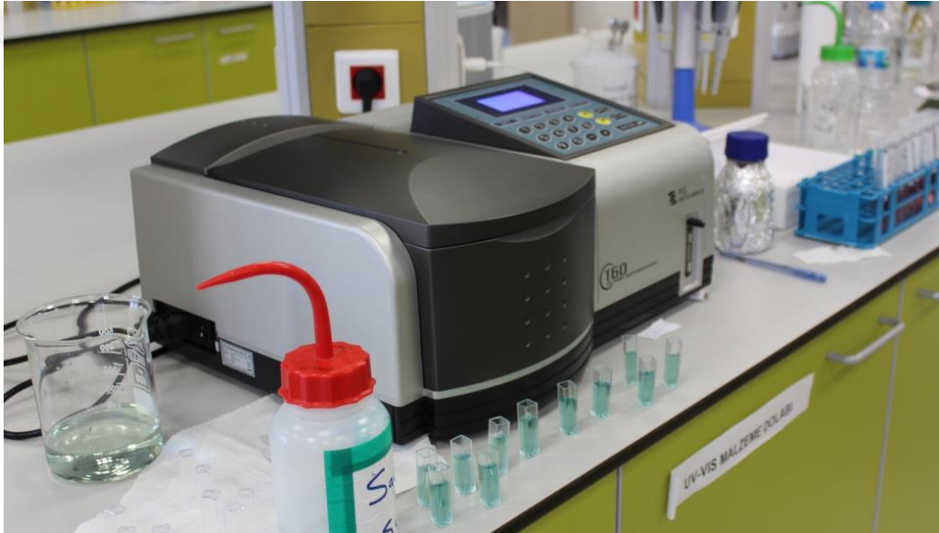
Fotoğraf 3.7. Fenolik ölçümlerde okuma için kullanılan spektrofotometre
