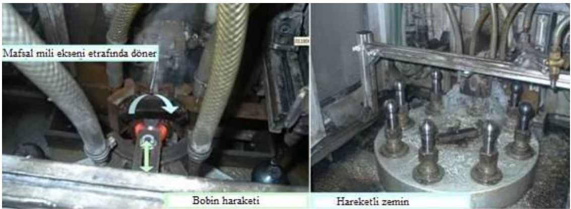
Fotoğraf 2.1. Rot başı mafsal milinin indüksiyon yüzey sertleştirme işlemi
