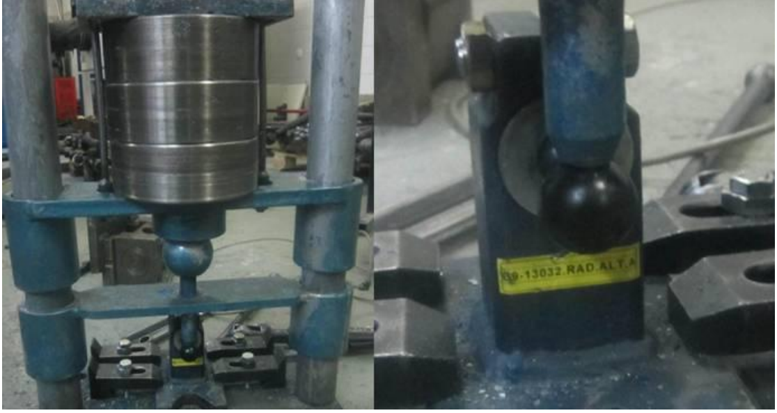
Fotoğraf 3.10. Darbe (İmpact) test istasyonu
