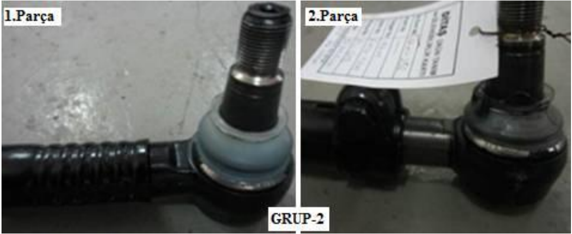
Fotoğraf 3.4. Grup-2 Mafsal millerinin yorulma test sonucu görüntüleri
