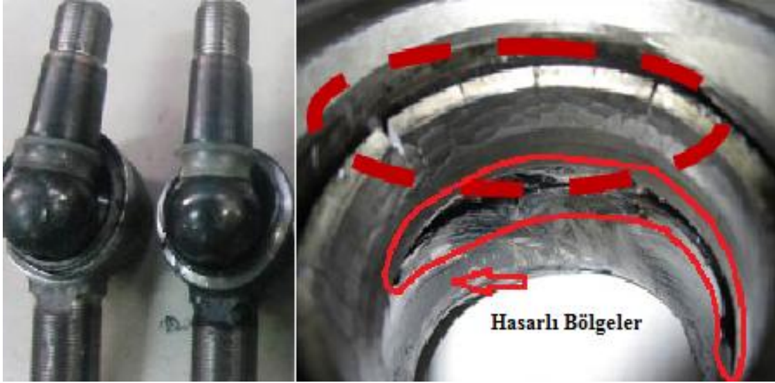
Fotoğraf 3.6. Pull out testi sonucunda gövdede meydana gelen deformasyon bölgeleri
