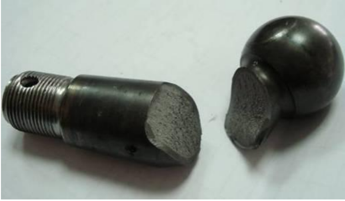
Fotoğraf 3.9. Mafsal milinin eğilme test sonucu görüntüsü
