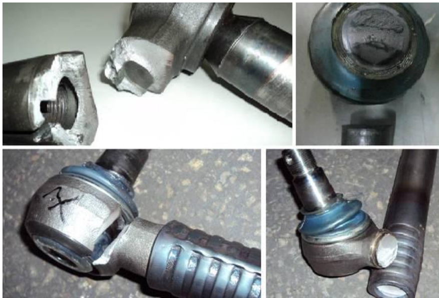
Fotoğraf 2.7. Malzeme yorulması sonucu çeşitli yerlerinden kırılmış rot başları
