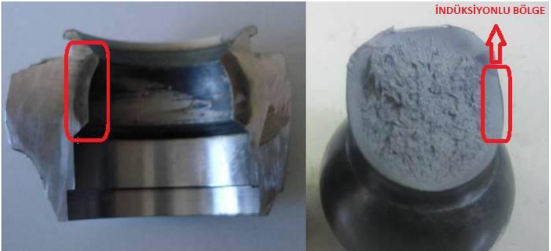
Fotoğraf 2.3. Rot başı gövdesinin ve mafsal milinin sertleştirilmiş kesit görüntüleri
