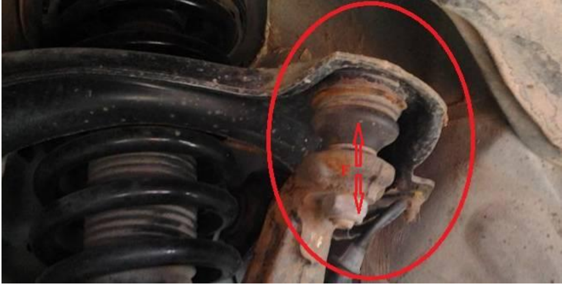
Fotoğraf 2.10. Rot başlarına gelen aksel kuvvetlerin gösterimi
