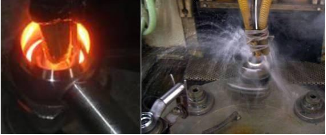
Fotoğraf 2.2. Rot başı gövdesinin indüksiyon yüzey sertleştirme işlemi
