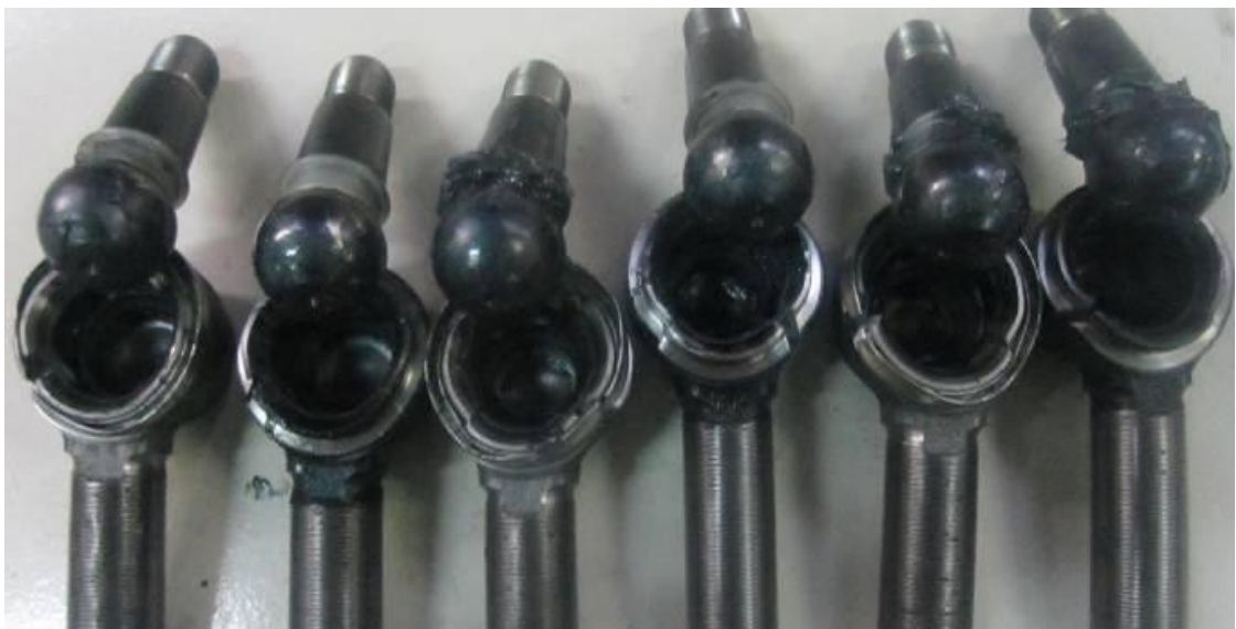
Fotoğraf 2.11. Aksel yüklemesi sonucunda hasara uğramış rot başları
