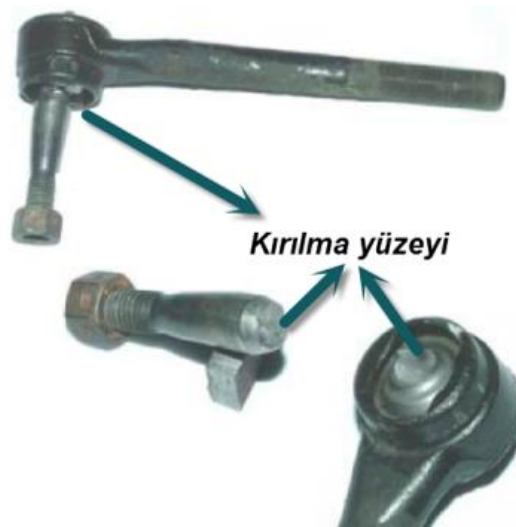
Fotoğraf 1.1. Rot kolunda yorulma ile meydana gelen hasar (Falah ve ark., 2007)
