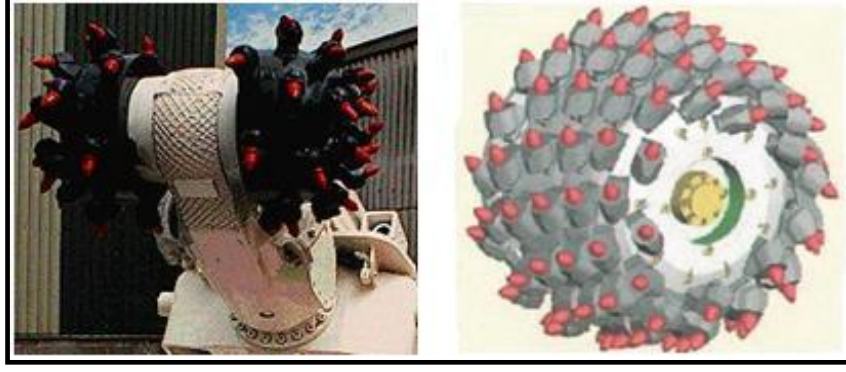
Şekil 2.5 Spiral ve tambur tip kesici kafalar [12, 17]
