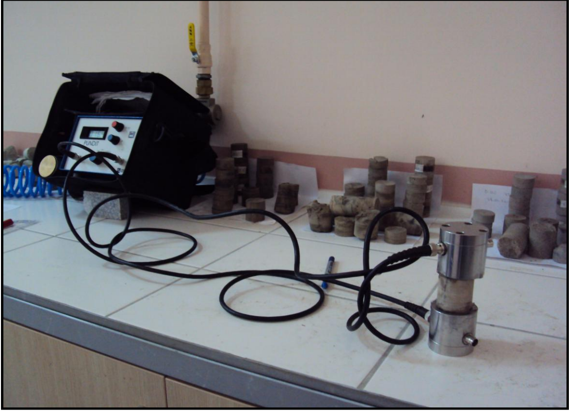
Fotoğraf 4.13 (b) Sonik hız deneyinin uygulanışı
