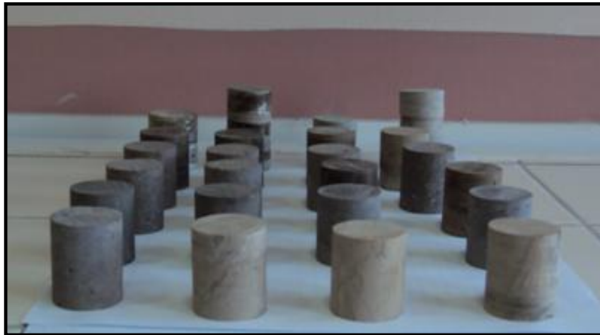
Fotoğraf 4.13 (a) Sonik hız deneyi uygulanan numuneler
