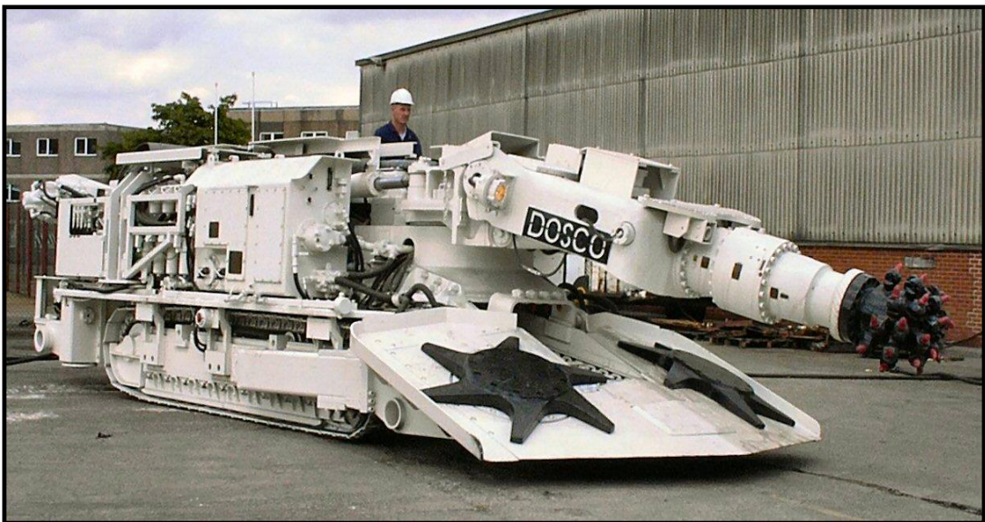
Fotoğraf 2.4 Dosco Mk2B kollu galeri açma makinesi[17]
