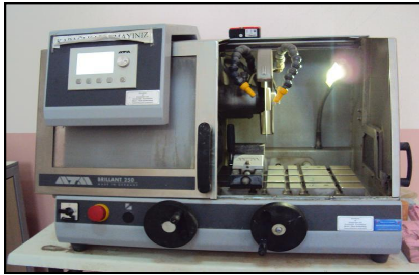
Fotoğraf 4.6 Kullanılan karot kesme makinesi
