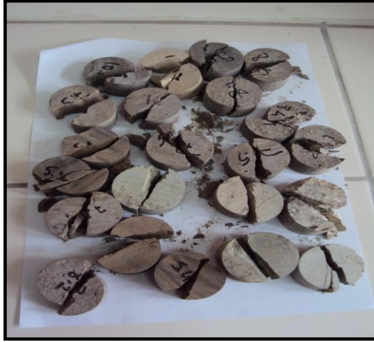
Fotoğraf 4.11 (b) Dolaylı çekme deneyi sırasında kırılan numuneler
