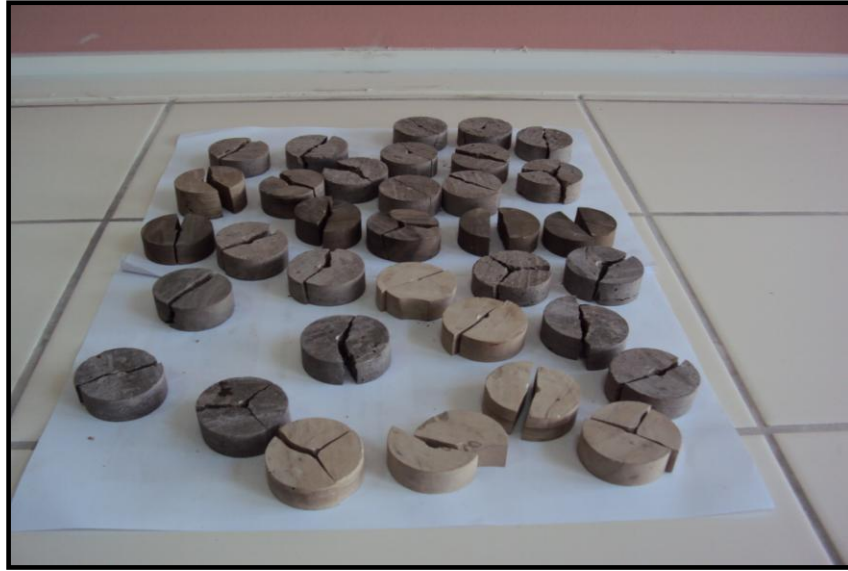
Fotoğraf 4.12 (b) Nokta yük dayanım testinde kırılan numuneler
