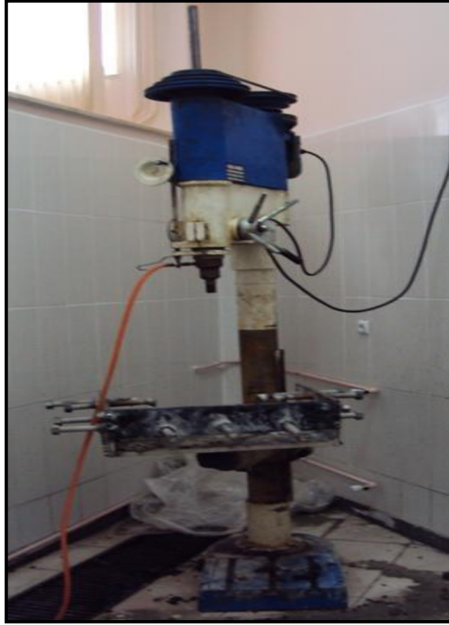
Fotoğraf 4.5 Karot numunelerin alınmasında kullanılan karot alma makinesi
