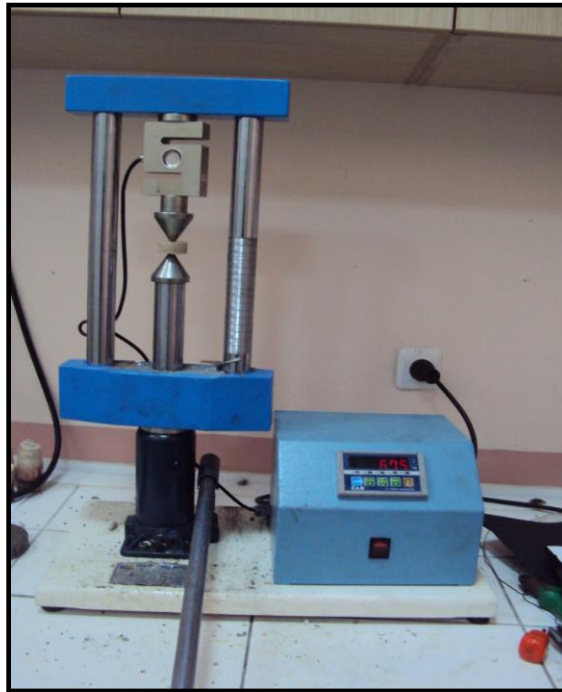
Fotoğraf 4.12 (a) Nokta yük dayanım testinin yapıldığı deney aleti
