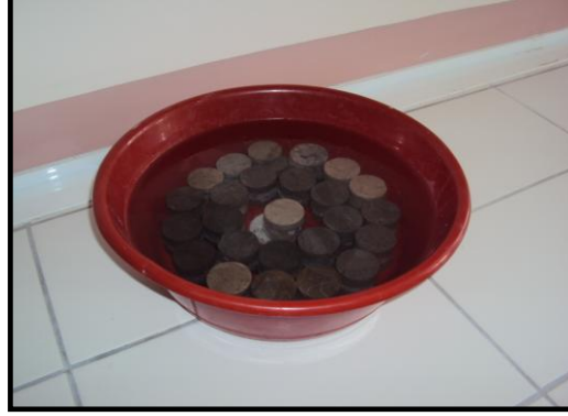
Fotoğraf 4.10. Numunelerin suya doyurulması işlemi
