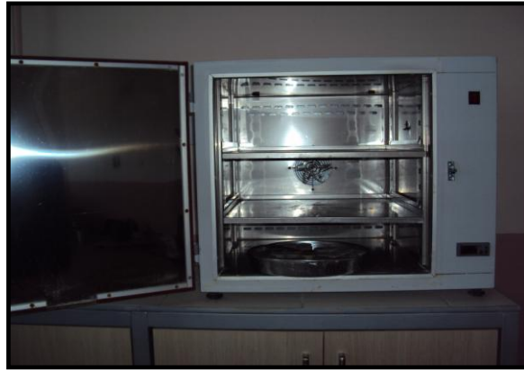
Fotoğraf 4.9 Numune kurutma işleminde kullanılan etüv
