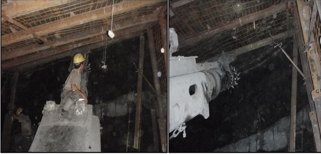
Fotoğraf 4.3 Dosco Mk2B kollu GAM' ın kullanıldığı tahkimat çalışması
