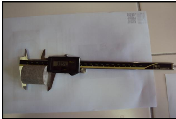
Fotoğraf 4.8 Dijital kumpas ile ölçüm
