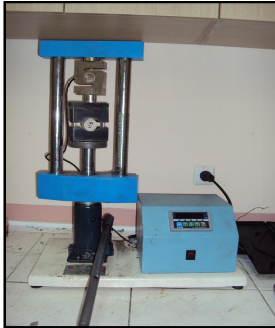
Fotoğraf 4.11 (a) Dolaylı çekme deneyinin yapılışı
