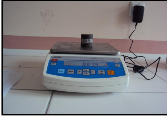
Fotoğraf 4.7 Yoğunluk için numunelerin tartımı
