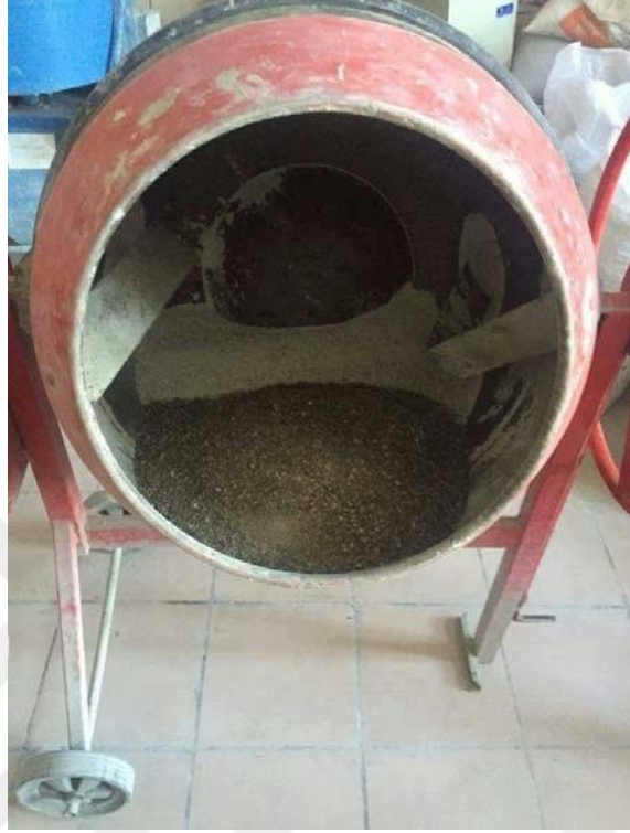
Fotoğraf 3.1. Taze betonun hazırlanması
