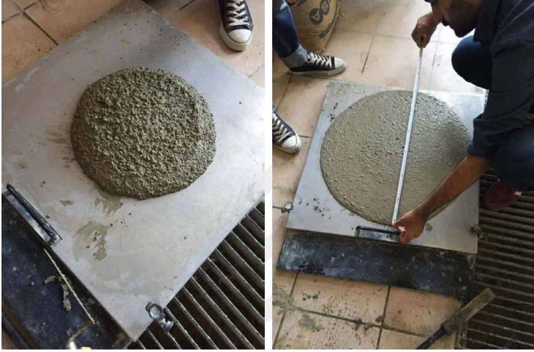
Fotoğraf 3.3. Yayılma tablası deneyi
