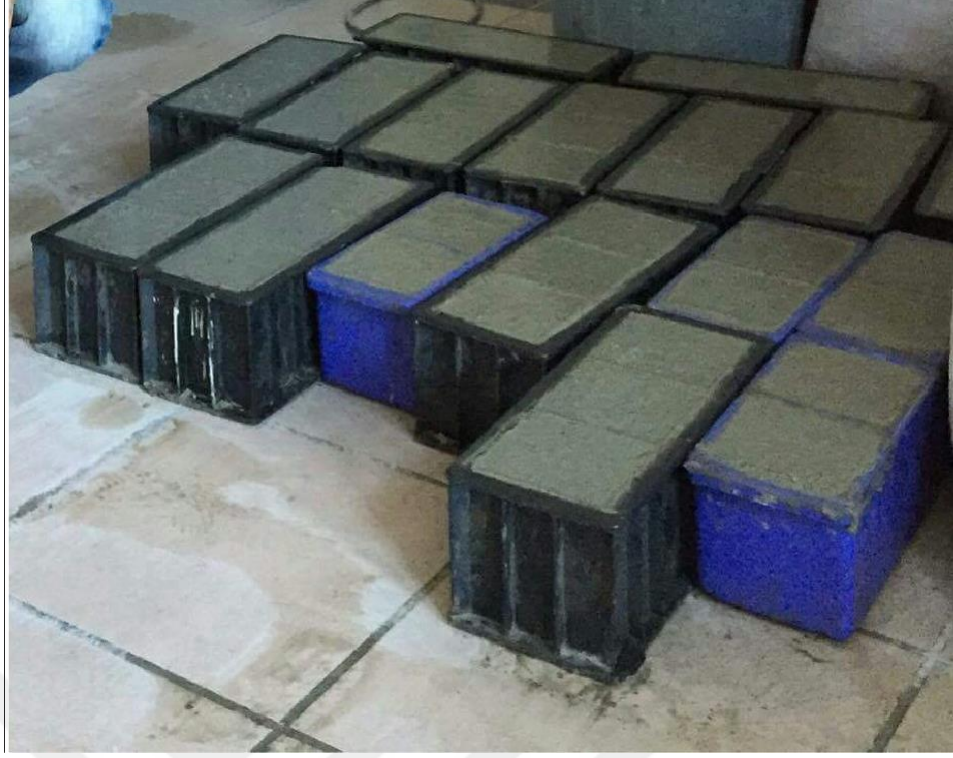
Fotoğraf 3.2. Taze betonların kalıplara yerleştirilmiş hali
