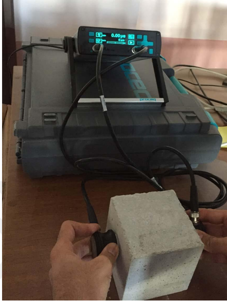
Fotoğraf 3.9. Numunelerin ultrases geiş hızının belirlenmesi
