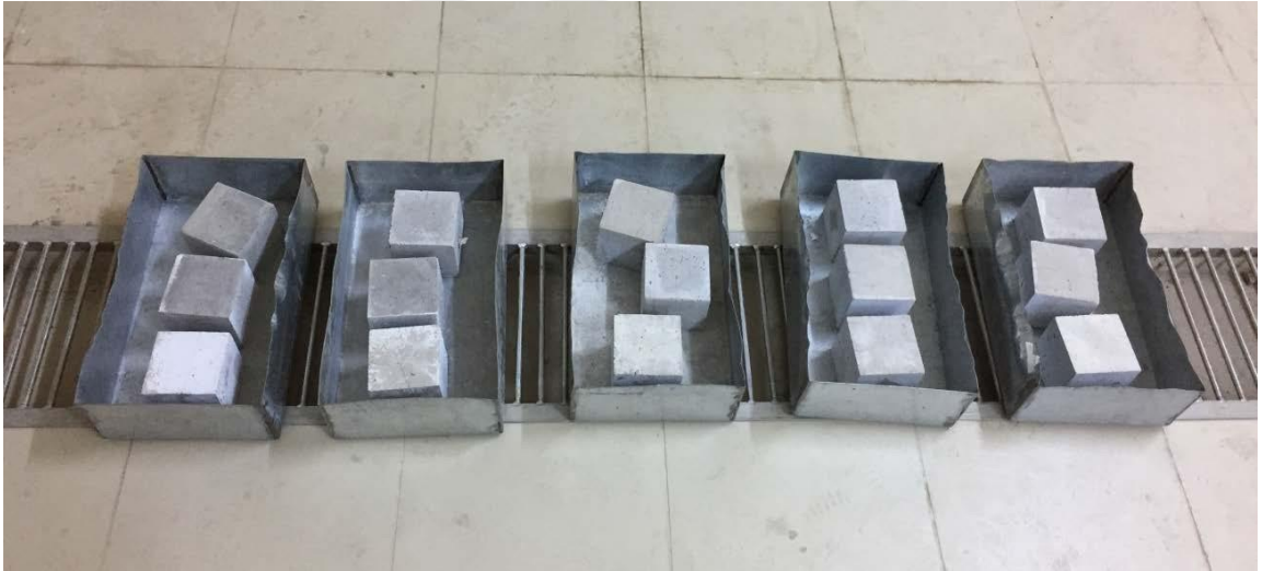
Fotoğraf 3.7. Numunelerin havada soğutulması
