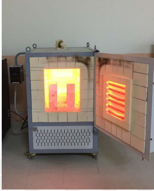
Fotoğraf 3.6. Deney numunelerinin yüksek sıcaklığa maruz bırakılması
