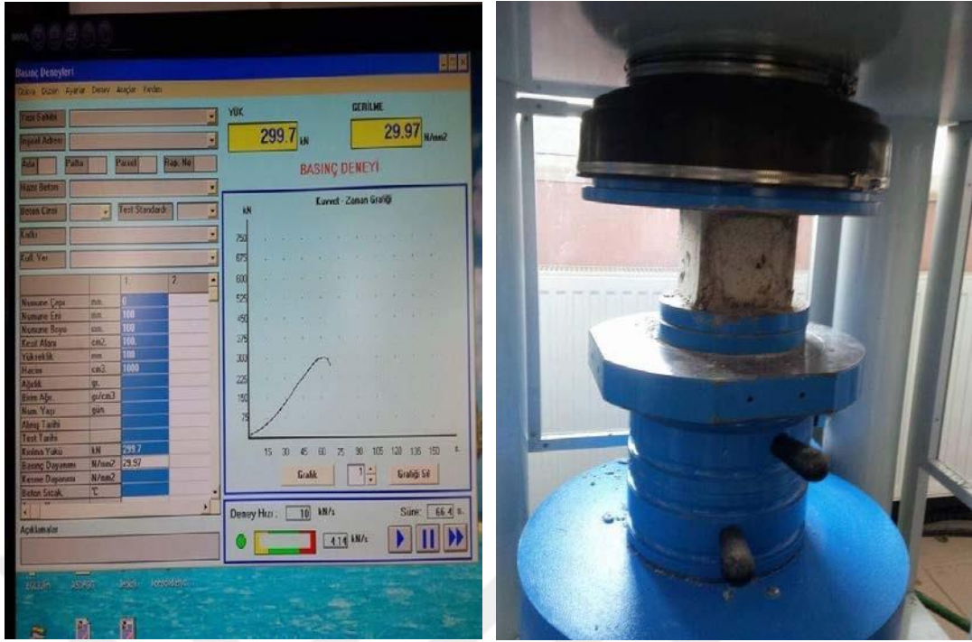
Fotoğraf 3.5. Basınç dayanımı test cihazı
