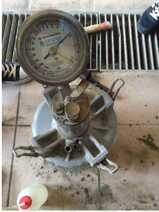
Fotoğraf 3.4. Betonda hava muhtevası ölçmesi için kullanılan deney aleti
