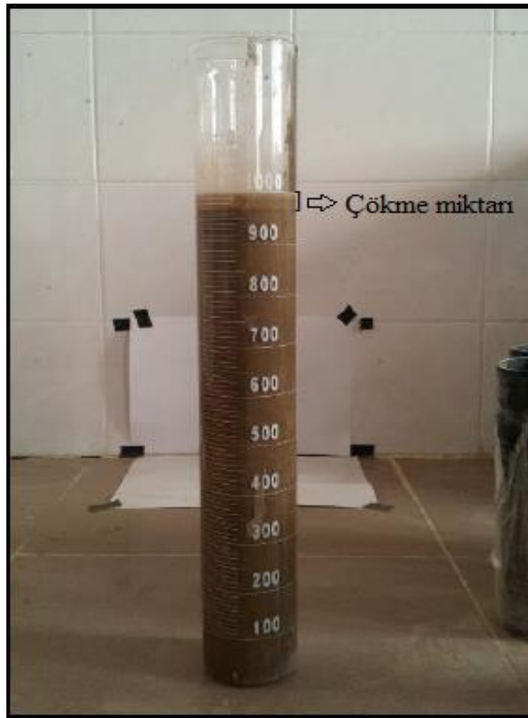
Fotoğraf 2.1. Bleeding (çökme) deneyi (Çelik, 2016)
