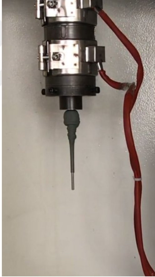
Fotoğraf 3.3. Düşük sıcaklık parafini ile yapılan denemenin ekstrüzyon çıkışı
