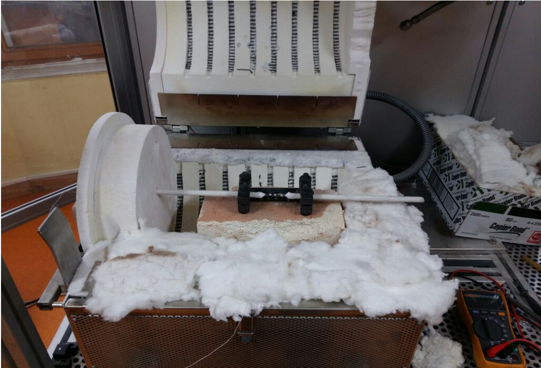
Fotoğraf 3.16. Test aparatının fırına yerleştirilmesi
