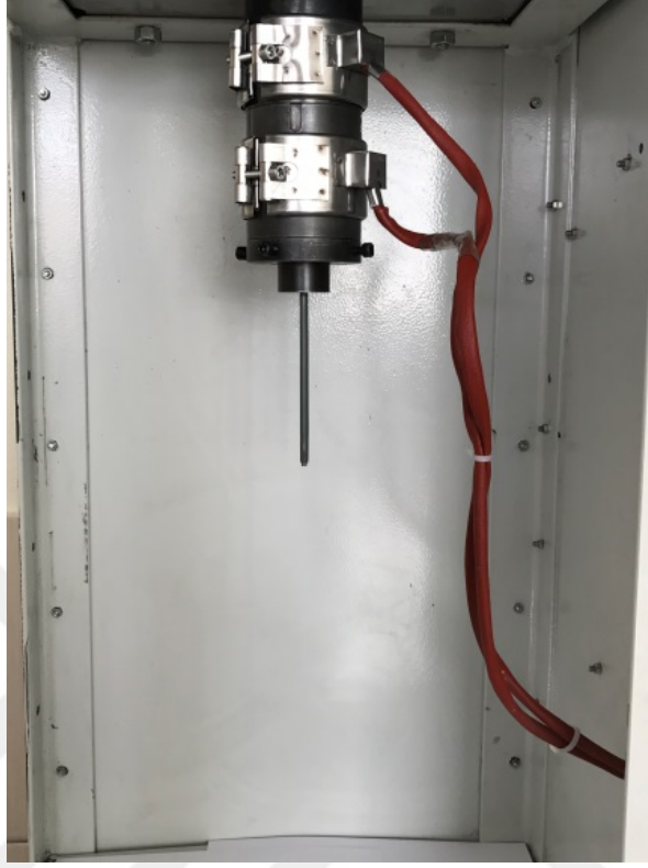
Fotoğraf 3.4. Orta sıcaklık parafini ile yapılan denemenin ekstrüzyon çıkışı
