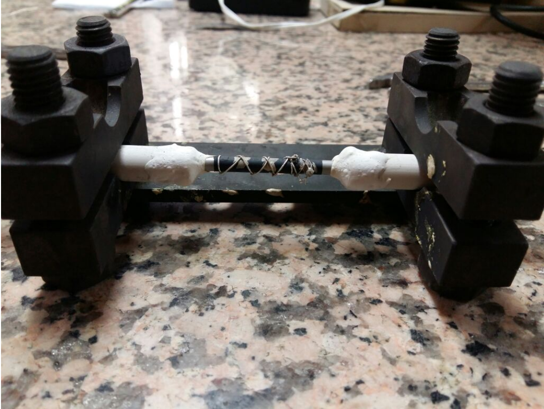
Fotoğraf 4.2. Test sonrası mikro-tüp KOYP ve test düzeneğinin görüntüsü
