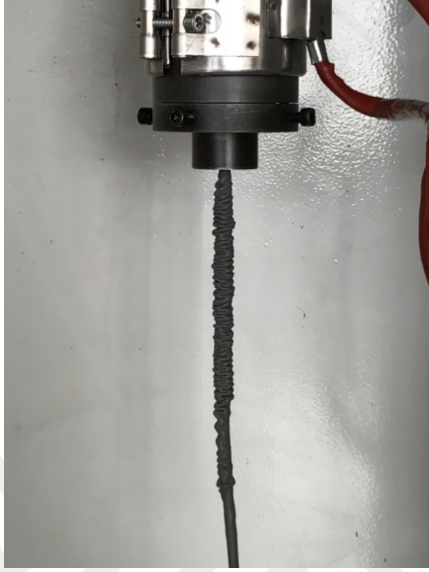
Fotoğraf 3.5. Yüksek sıcaklık parafini ile yapılan denemenin ekstrüzyon çıkışı
