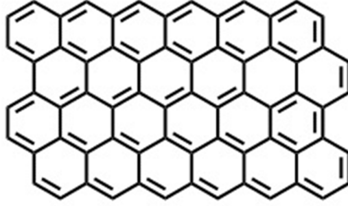
Şekil 4.5. İndirgenmiş grafen oksitin yapısı
