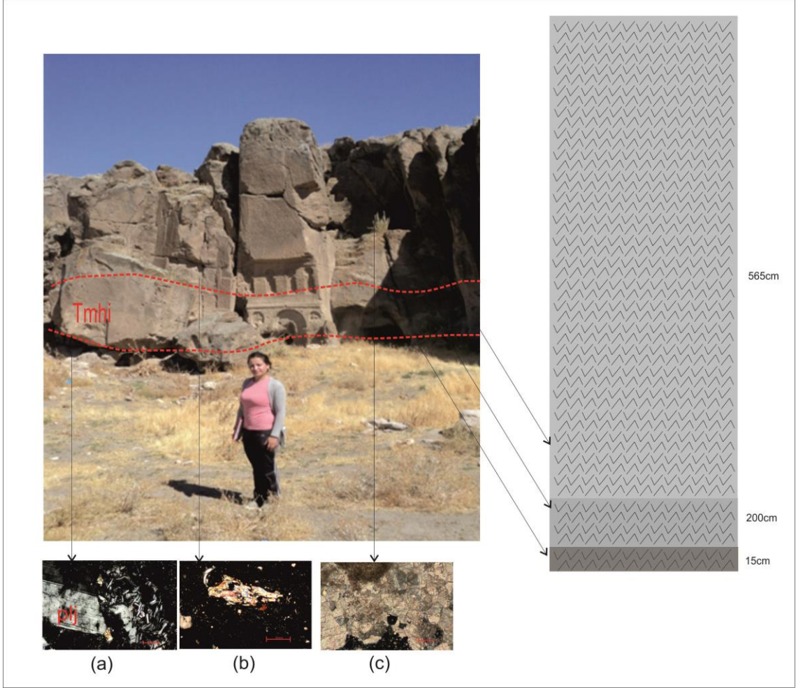
Şekil 5. 13. Karamahmutlu köyü x: 44,905 y: 88,399, x: 44,905 y: 88,399 ve x: 44,905 y: 88,399 koordinatlardan alınan örnek lokasyonları ve çift nikol mikroskop görüntüleri, arazi görüntüsü ve örnek lokasyonu, (a) andezitik bazalt, (b) piroksen ve
