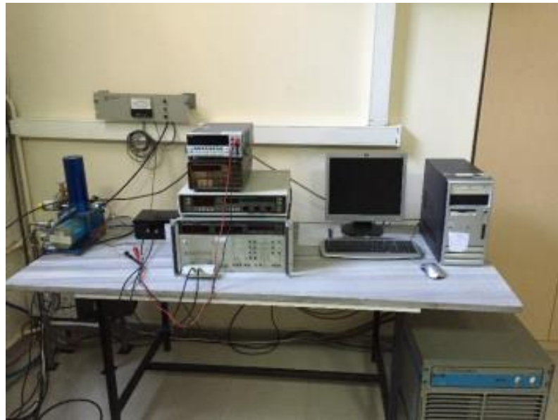
Şekil 3.5. Akım-gerilim ( I - V ) ve kapasitans-gerilim ( C - V ) ölçümleri için kullanılan düzeneğin bir resmi (Güllü, 2016)
