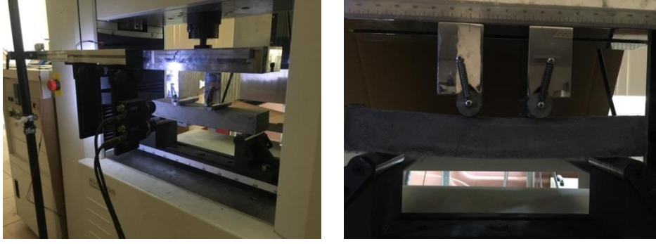
Fotoğraf 3.7. Üniversal test sistemi ve ECC'nin dört noktalı eğilmede çekme testi sırasındaki davranışı
