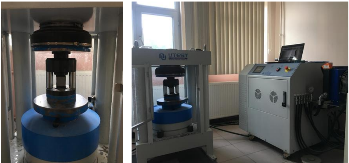
Fotoğraf 3.6. Basınç dayanımı test cihazı ve basınç dayanımının belirlenmesi
