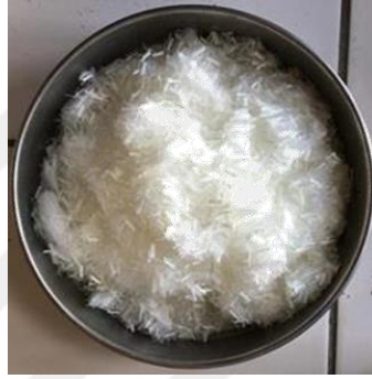
Fotoğraf 3.3 ECC karışımlarında kullanılan PVA lifi
