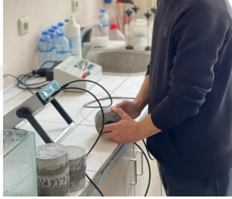
Fotoğraf 3.10. ECC karışımlarının UTH ölçümü
