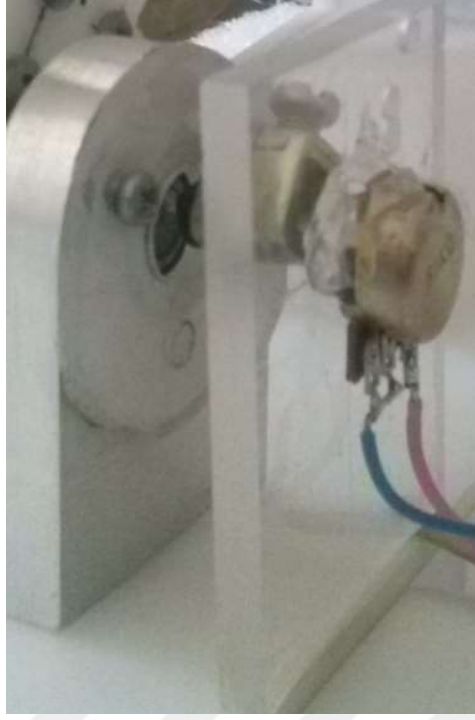
Fotoğraf 2.2. Enkoder yerine kullanılan potansiyometrenin birleştirilmesi
