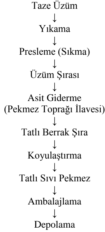
Şekil 2.1. Geleneksel yöntemlerle tatlı sıvı pekmez üretim aşamaları
