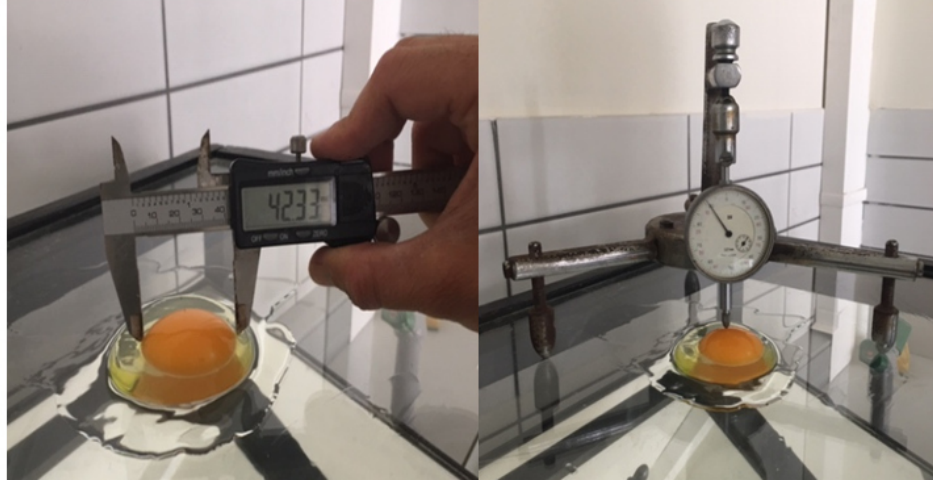
Fotoğraf 2.13. Dijital kumpas ve üçayaklı mikrometre ile ölçüm
