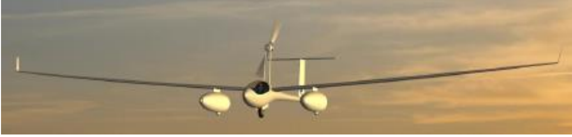
Fotođraf 1.1. Yakıt pili ile alıřan Sınıf III kapasitesinde uak sistemi, Antares DLR
