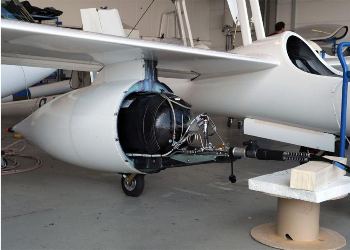
Fotođraf 1.2. Antares DLR üzerinde bulunan kompozit hidrojen tp
