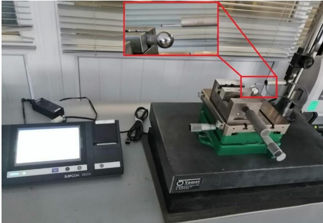
Şekil 3.4. Yüzey pürüzlülük ölçüm cihazı ile ölçüm yapılması
