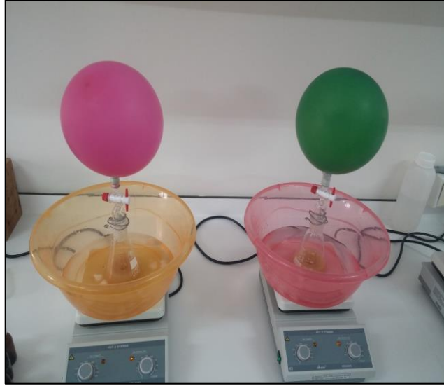
Şekil 3.6. Doğal aromalı içeceğin azot gazı altında sıvı-sıvı ekstraksiyonu
