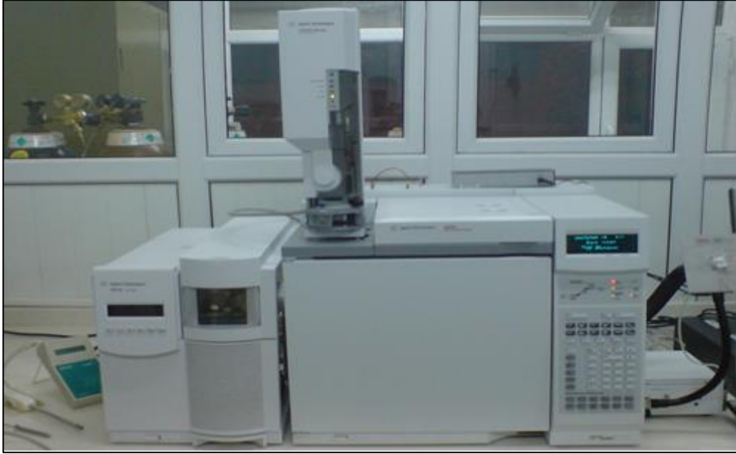
Şekil 3.7. GC-FID ve GC-MS sistemi (Tangüler, 2010)
