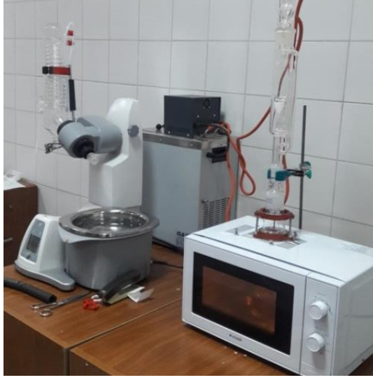
Şekil 3.3. Mikrodalga destekli modifiye Soxhlet ekstraksiyon düzeneği
