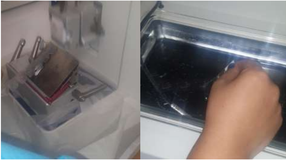
Fotoğraf 3.3. Mikrotom ile kesit alma ve su banyosunda kesitlerin lamlara aktarılması
