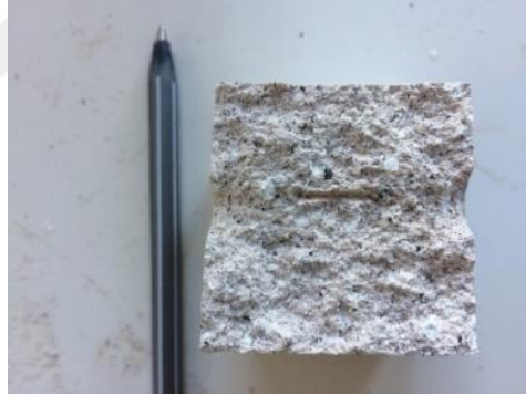
Şekil 4.8. Cerchar aşınma testi sonunda kayaç yüzeyinde oluşan aşınma (Aktaş)
