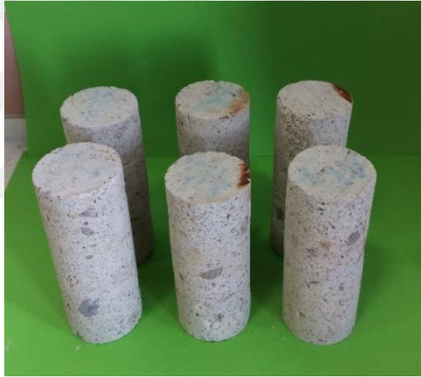
Şekil 4.6. Tek eksenli basınç dayanımı deneyinde kullanılan silindirik örnekler
