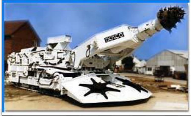
Şekil 2.1. Aynaya dik dönme eksenli kafalı kollu galeri açma makinesi (Çomaklı, 2010)
