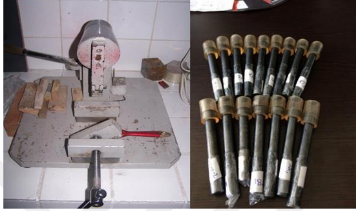
Şekil 4.7. Cerchar aşındırıcılık deney aleti ve deneyde kullanılan uçlar
