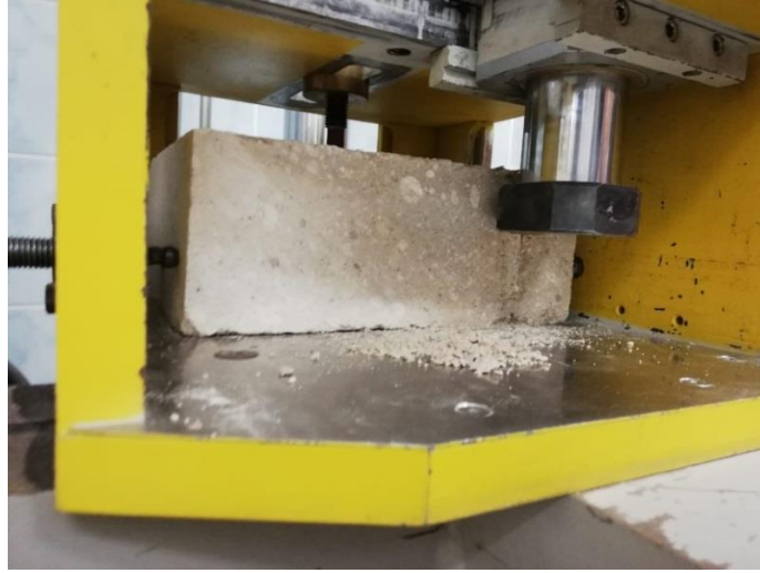
Şekil 4.10. Aktaş 3 numunesi üzerinde kama uçlu keski kullanılarak yapılan kaya kesme deneyleri
