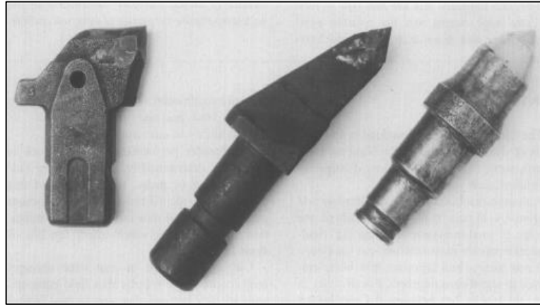
Şekil 2.5. Kollu galeri açma makinelerinde kullanılan keski (Polat, 2015)
