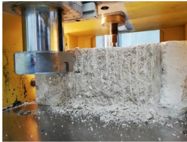
Őekil 4.12. Nar 2 numunesi zerinde yardımlı kaya kesme deneyi sonrası
