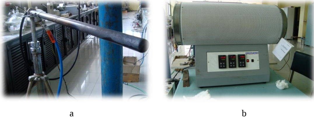
Fotoğraf 3.2 Isıl işlemde kullanılan paslanmaz çelik tüp (a) ve fırın (b)
