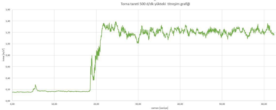
Şekil 5.7. Cihazdan alınan verilere göre analiz edilmiş, 500 devir 0.5 mm talaş kaldırma işleminde titreşim değişim eğrisi
