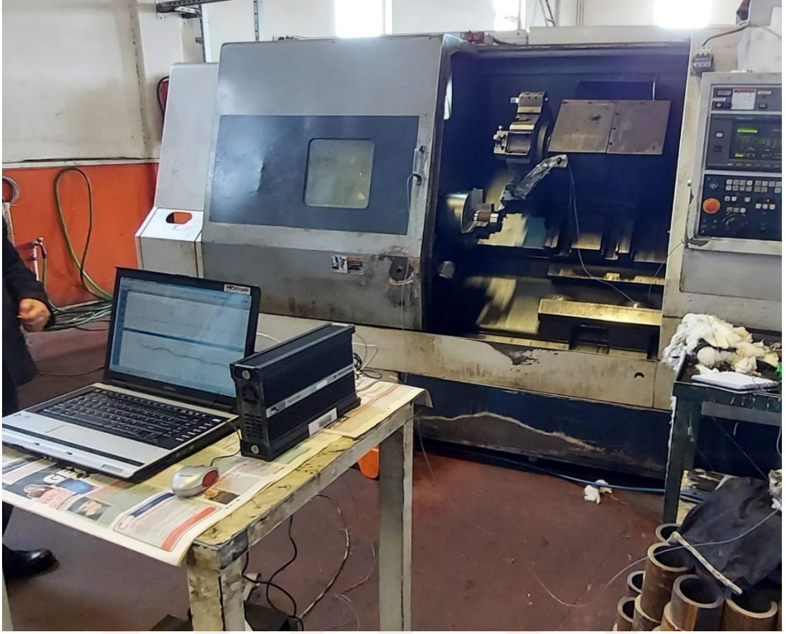
Fotoğraf 5.1. CNC torna tezgâhı titreşim ölçüm deney düzeneği görünümü
