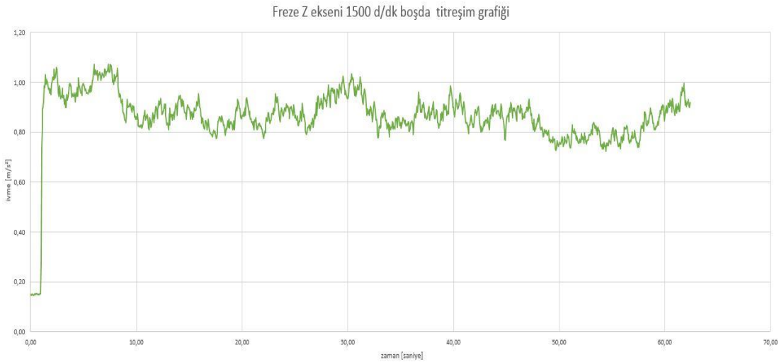
Şekil 5.33. Cihazdan alınan verilere göre analiz edilmiş, 1500 devir boşta dönme işleminde z eksenli titreşim değişim eğrisi
