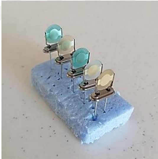
Fotoğraf 4.3. Kaplanmış QCM sensör örnekleri
