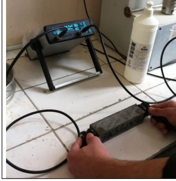
Fotoğraf 3.15. 160 mm'lik numunede UTS deneyi uygulaması
