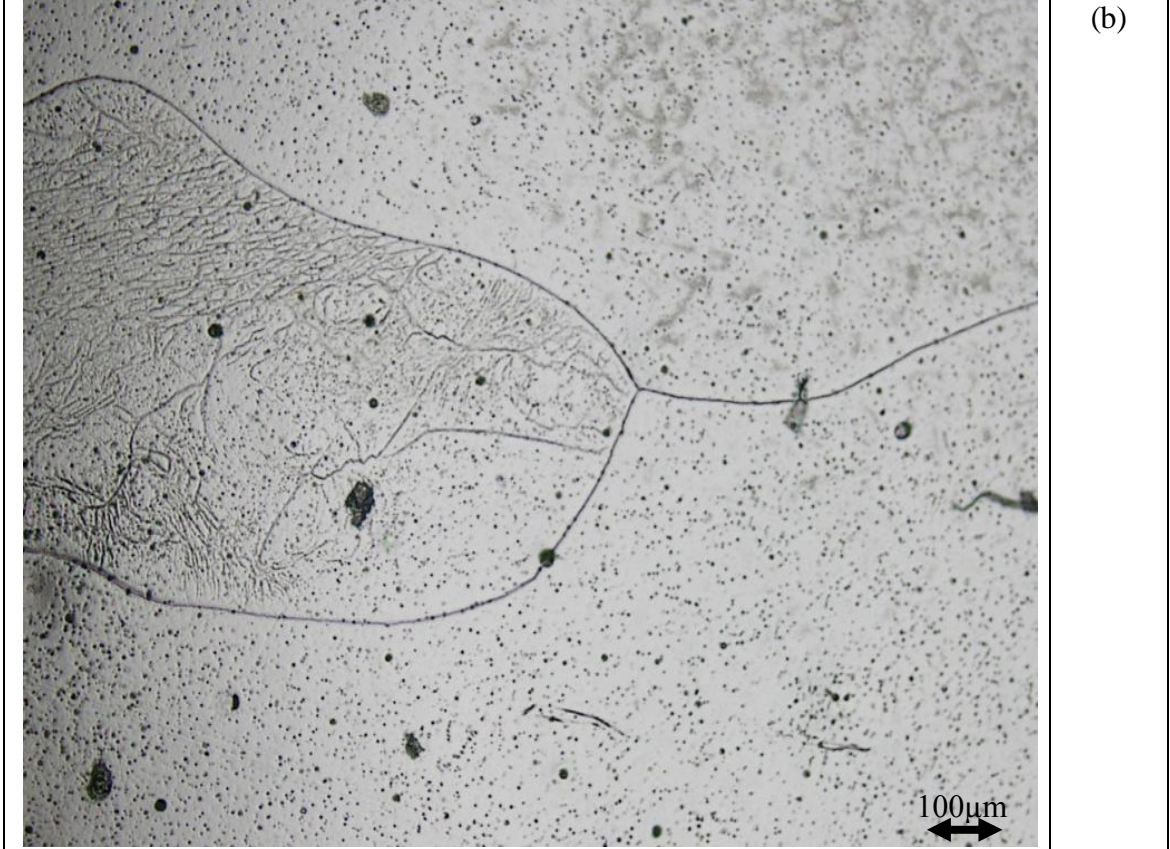
Fotoğraf 5.2 (a)Fe-%40Ni-%2Si alaşımında (b)Fe-%40Ni-%5Si alaşımında 100°C' de bulunan austenite yapı ve tane sınırları
