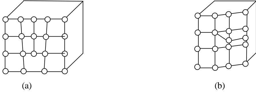
Şekil 3.2 (a) Kenar dislokasyonları, (b) Vida dislokasyonları
