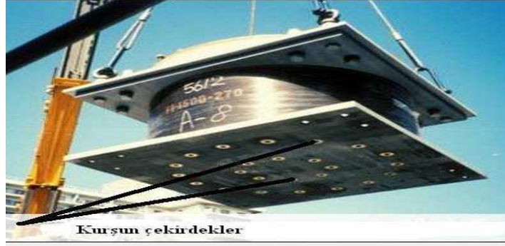
Fotoğraf 4.5. Birden fazla kurşun çekirdekli kauçuk izolatör modeli (Demir, 2008)
