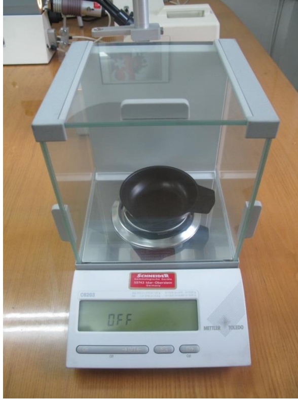
Fotoğraf 2.5. Yoğunluk ölçümünde kullanılan hassas terazi (İTÜ-Gemoloji Lab.)
