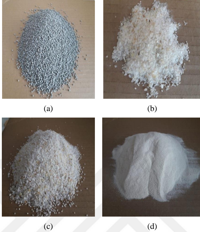
Fotograf 3.2. 1,2-2,5 mm uçucu kül agregası (a), 1,2-2,5 mm kuvars agregası (b), 0,6-1,2 mm kuvars agregası (c) ve 0-0,4 mm kuvartz agregası (d)
