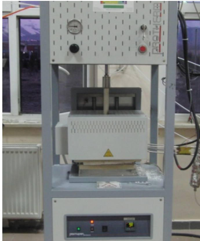
Fotoğraf 3.2 Hazırlanan deneyin pnomatik fırına yerleştirilip kablo bağlantılarının yapılması
