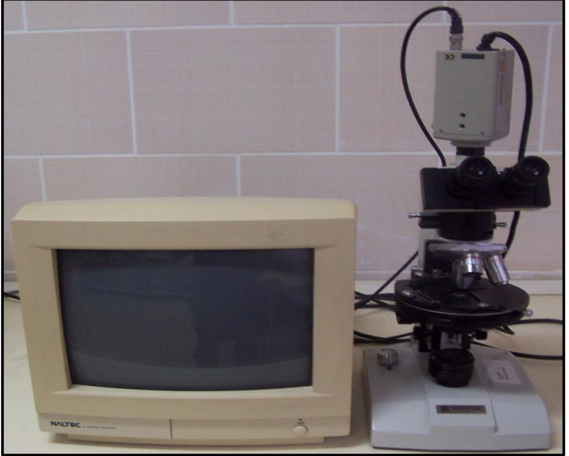
Fotoğraf 3.1. Mineralojik - petrografik incelemelerde kullanılan polarizan mikroskop
