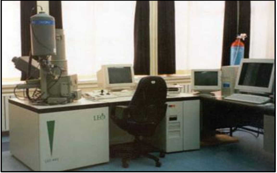
Fotoğraf 3.2. Erciyes Üniversitesi Teknoloji Araştırma ve Uygulama Merkezi (TAUM)'nde bulunan Elektron Mikroskobu (MODEL: LEO 440 COMPUTER CONTROLLED DIGITAL)
