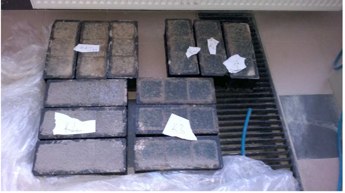
Fotoğraf 3.4. Taze betonların kalıplara yerleştirilmiş hali
