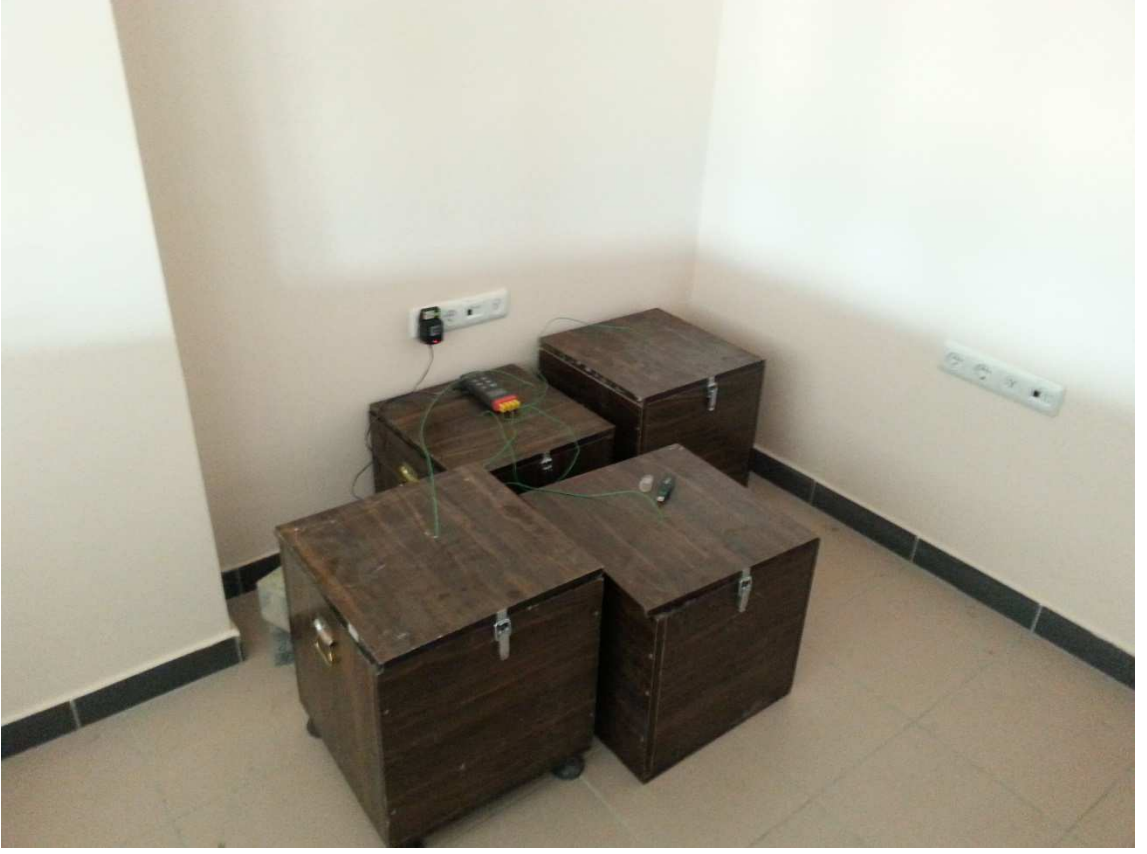
Fotoğraf 3.8. Sıcaklık ölçme düzeneđi
