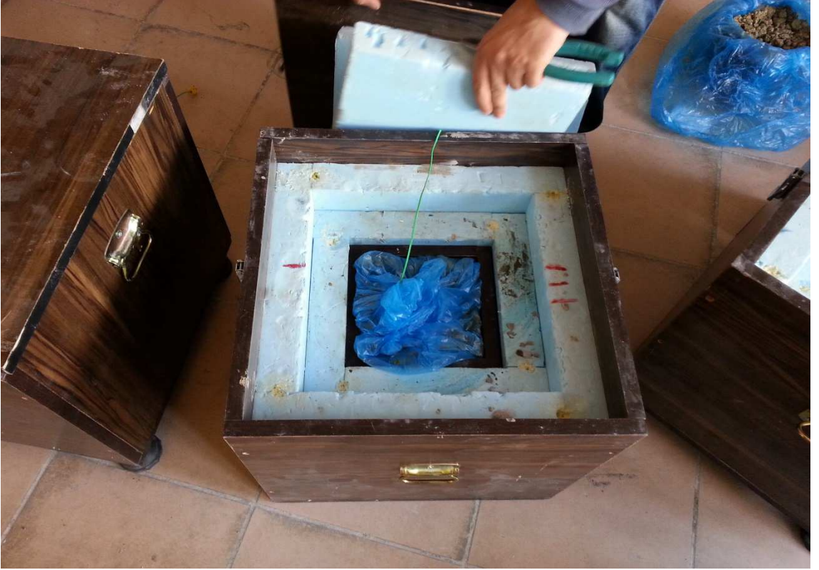
Fotoğraf 3.7. Thermocouple'ın beton içine yerleştirilmesi
