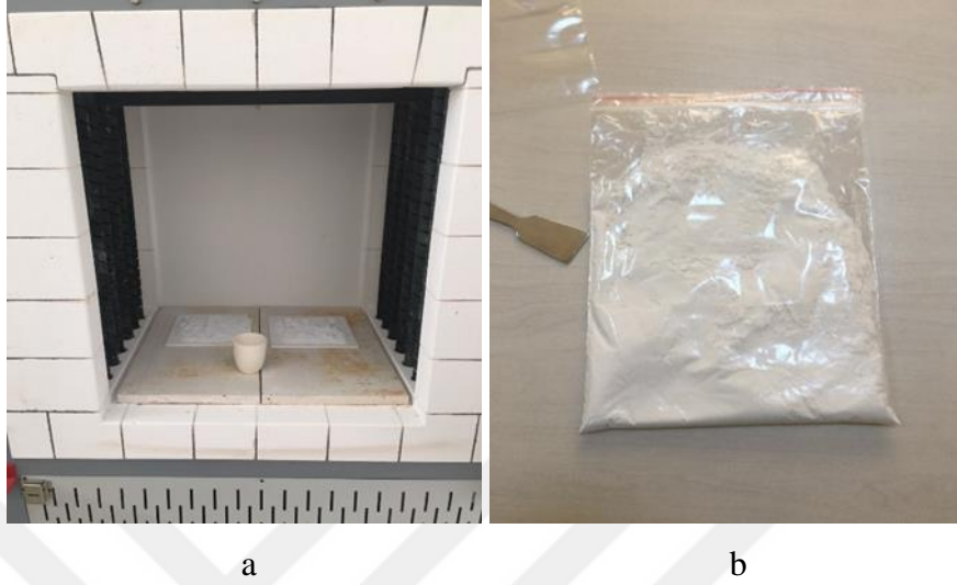
Fotoğraf 3.8. Tobermoritin kül fırına yerleştirilmesi (a) ve vollastonit (b)
