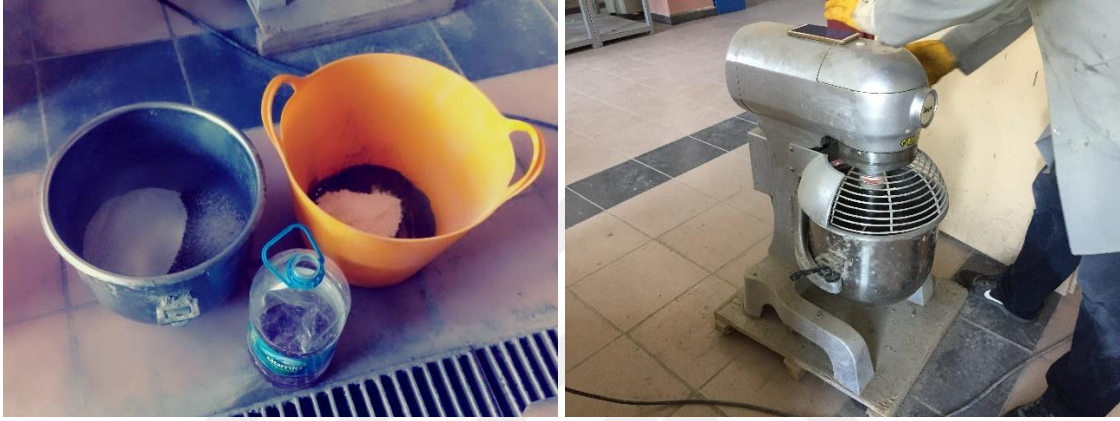
Fotoğraf 3.13. Karışımında kullanılan malzemeler (a) ve harç mikseri (b)
