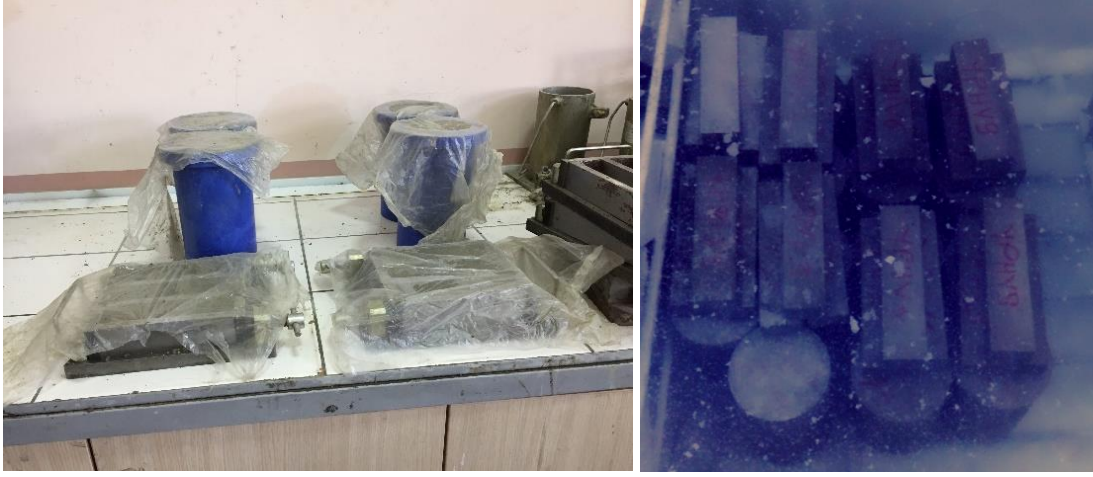
Fotoğraf 3.15. Prizmatik ve silindir numunelerin 24 saat kalıpta üzeri örtülü halde bekletilmesi (a) ve harç numunelerin kür havuzunda bekletilmesi (b)
