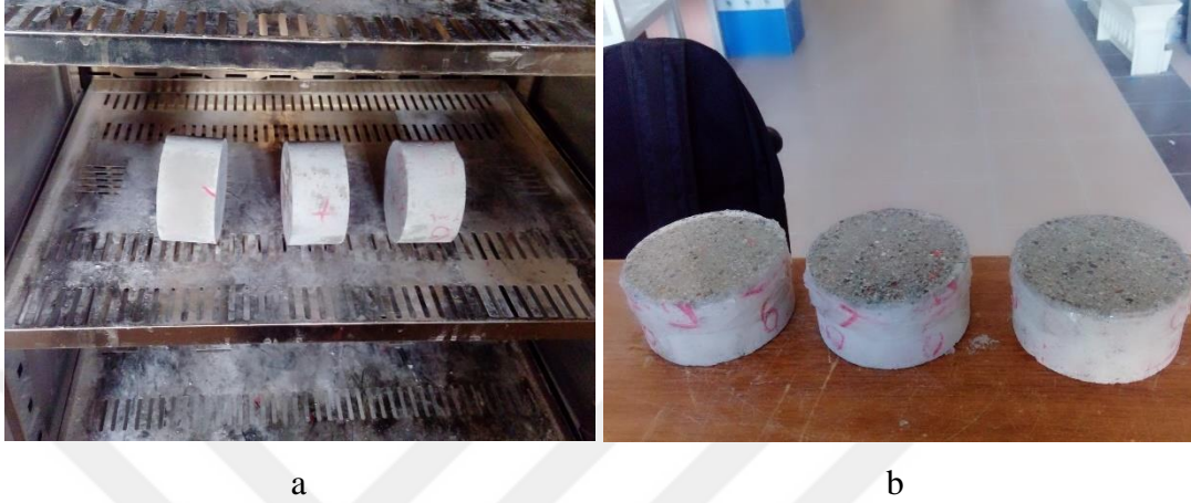
Fotoğraf 3.24. Etüvde kurutulan numuneler (a) ve silikonlanmış numuneler (b)
