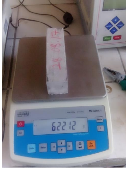
Fotoğraf 3.20. Prizmatik numunenin ağırlık tespiti
