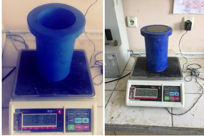
Fotoğraf 3.19. Silindir kabın boş ağırlığı (a) ve silindir kabın dolu ağırlığı (b)
