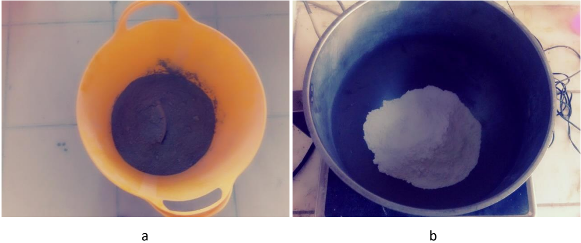
Fotoğraf 3.10. CEM I 42,5 R Portland çimentosu (a) ve sentetik vollastonit minerali (b)
