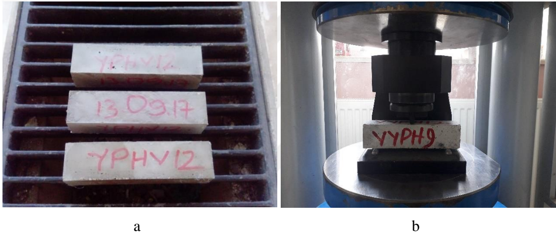
Fotoğraf 3.22. Eğilme deneyinde kullanılan 4x4x16 cm boyutlarında prizmatik numuneler (a) ve eğilme deneyi cihazı (b)
