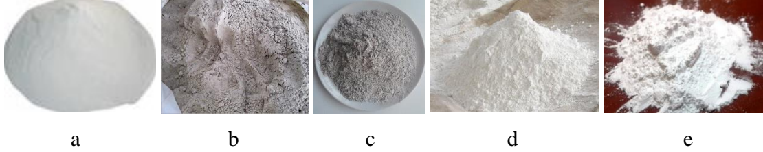
Fotoğraf 2.1. Silis dumanı (a), uçucu kül (b), yüksek fırın cürufu (c), metakaolin (d) ve cam tozu (e) görüntüleri
