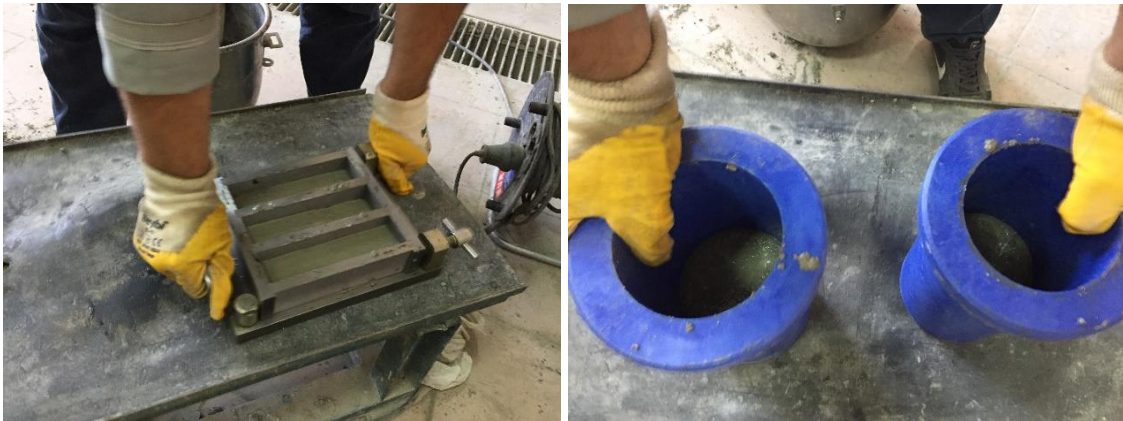
Fotoğraf 3.14. Prizmatik numunelerin sarsma tablasında sıkıştırılması (a) ve silindir numunelerin sarsma tablasında sıkıştırılması (b)
