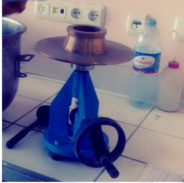
Fotoğraf 3.16. Yayılma tablası ve akış kalıbı
