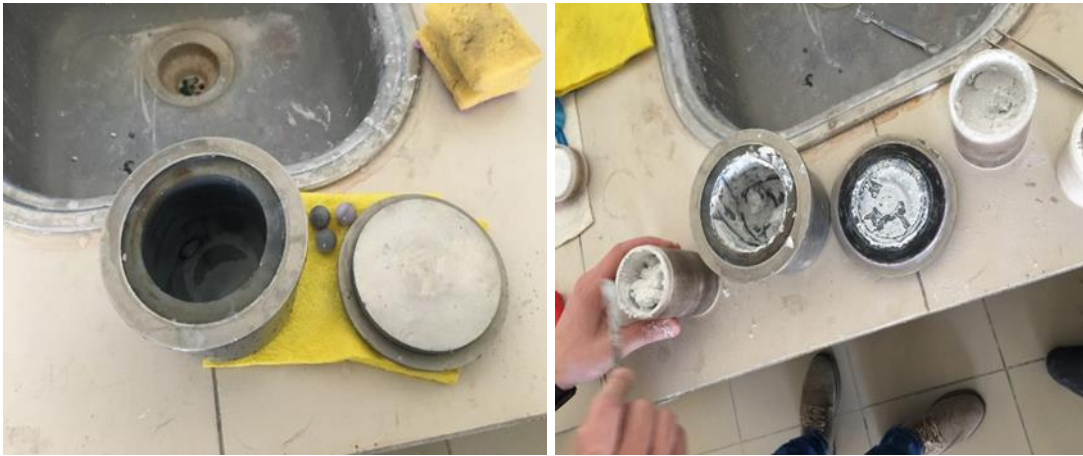
Fotoğraf 3.5. Bilyeli kap (a) ve otoklav için hazırlanan karışım (b)
