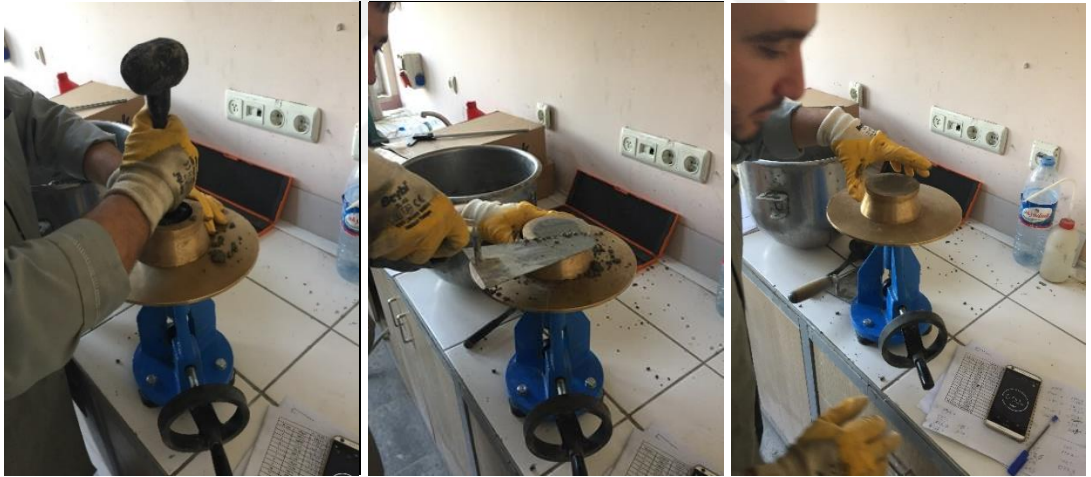
Fotoğraf 3.17. Birinci tabakanın şişenmesi (a), kalıp yüzeyinin mala yardımıyla düzeltilmesi (b) ve kalıbın harçtan kaldırılması (c)
