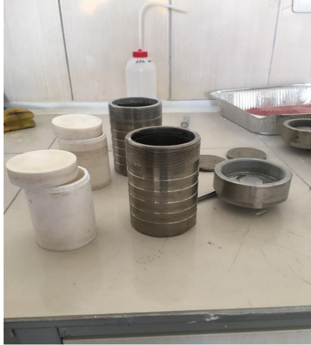
Fotoğraf 3.1. Hidrotermal otoklav reaktörü
