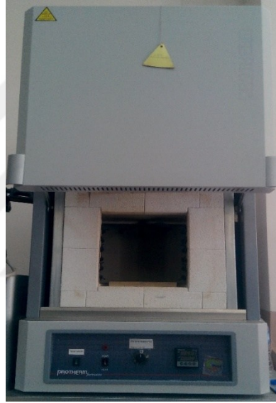
Fotoğraf 4.3. Fırında sertleştirme işlemi gerçekleştirilen PROTHERM marka fırın
