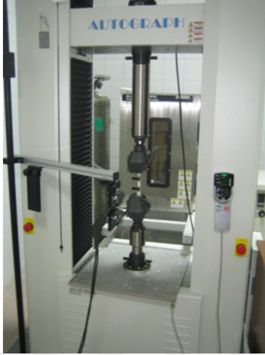
Fotoğraf 4.2. Shimadzu Autograph 100 kN mekanik çekme cihazı
