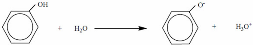
Şekil 3.10 Bazik ortamda fenolün iyonlaşmasıyla meydana gelen fenolat iyonu
