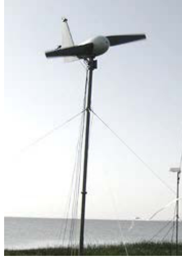
Fotoğraf 1.1. Yatay eksenli rüzgâr türbininde kuyruk kullanımı (Afanasyeva vd., 2016)
