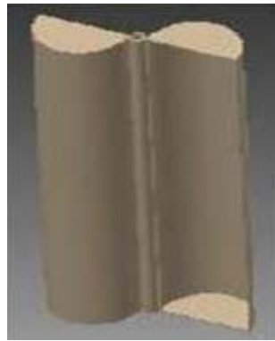
Şekil 1.4. Savonius tipi rüzgâr türbini (Alit vd., 2017)
