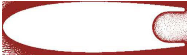
Şekil 1.14. Firar kenarında oyuk oluşturulmuş kanat profili (Kumar vd., 2017)
