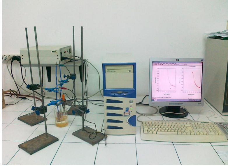
Fotoğraf 4.6. HCH Instruments Electrochemical Workstation cihazı ve deney düzeneği
