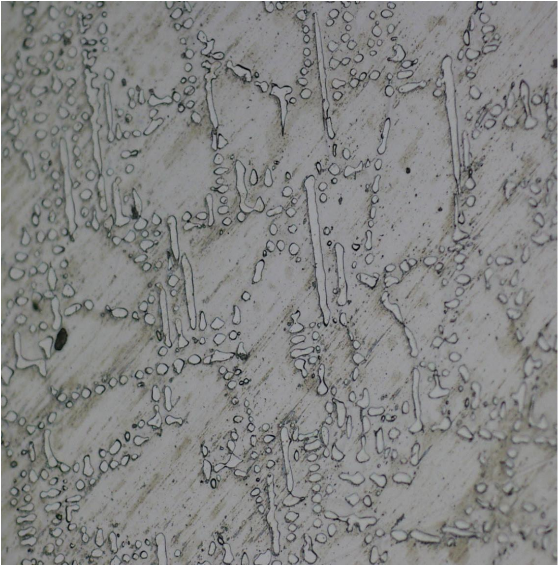
Fotođraf 5.1. Co-%40Mn-%5Si alařımında oda sıcaklıđında 90 ml metanol ve 10 ml HNO 3 dađlayıcı kullanılarak bulunan interdentrit yapı
