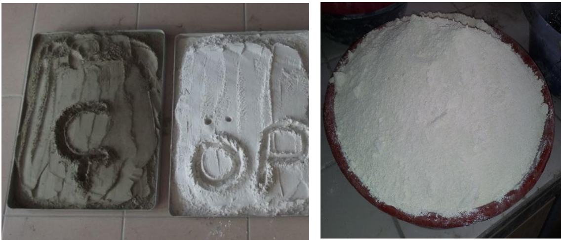
Fotoğraf 3.1. Çimento, metakaolin ve öğütülmüş pomzanın görünümü
