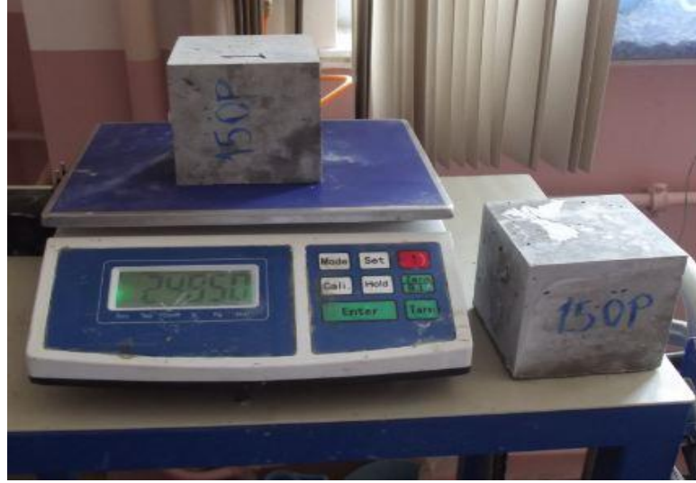
Fotoğraf 3.5. Sertleşmiş birim ağırlık deneyinin yapılışı
