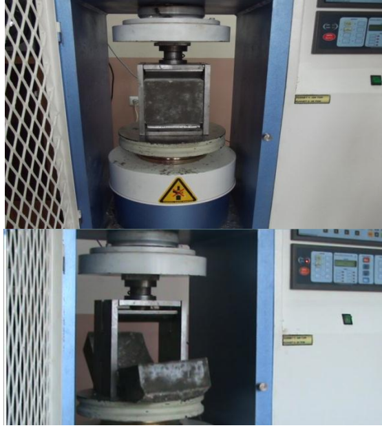
Fotoğraf 3.8. Yarmada çekme dayanımı deneyinin yapılışı
