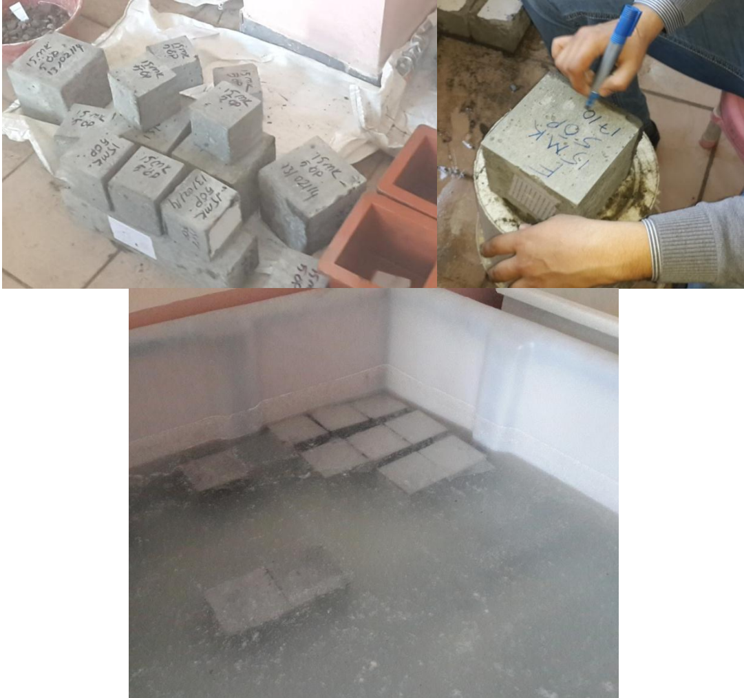
Fotoğraf 3.4. Sertleşmiş beton numunelerin görünümü
