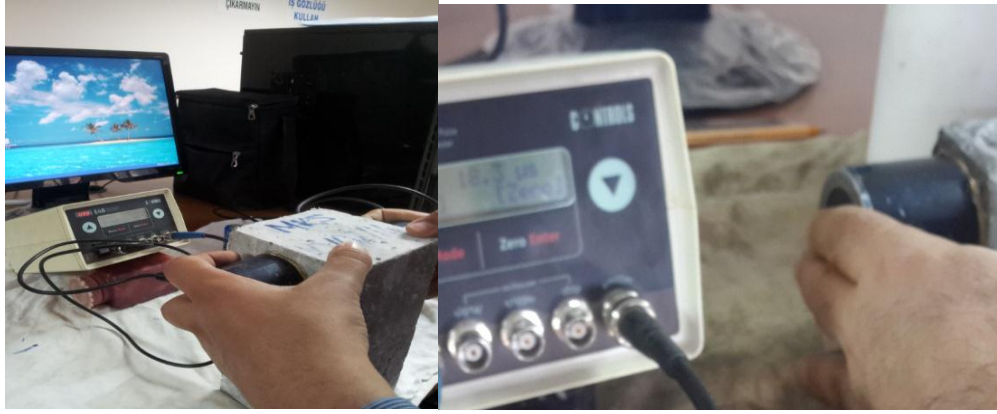
Fotoğraf 3.6. Ultrases geçiş hızı deneyinin yapılışı
