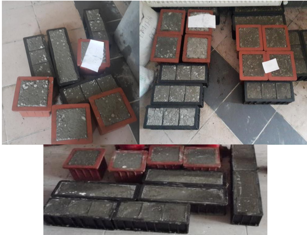
Fotoğraf 3.3. Taze betonun kalıplara yerleştirilmiş görünümü
