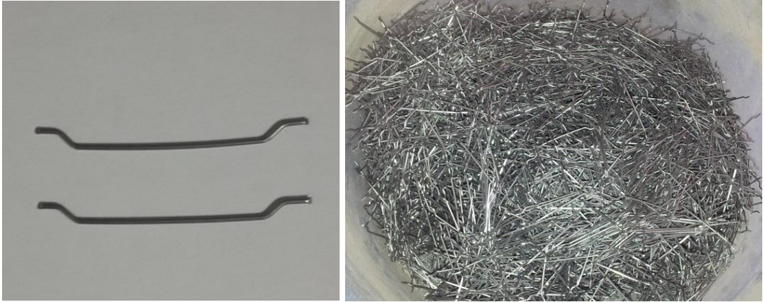
Fotoğraf 3.2. Beton karışımlarında kullanılan çelik fiberin görünümü
