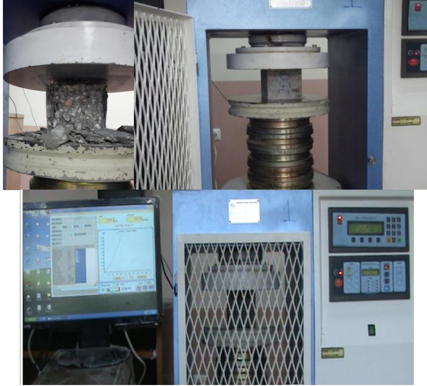
Fotoğraf 3.7. Basınç dayanımı deneyinin yapılışı
