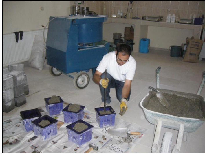
Şekil 2.5. Test için hazırlanan taze betonun küp kalıplara yerleştirilmesi
