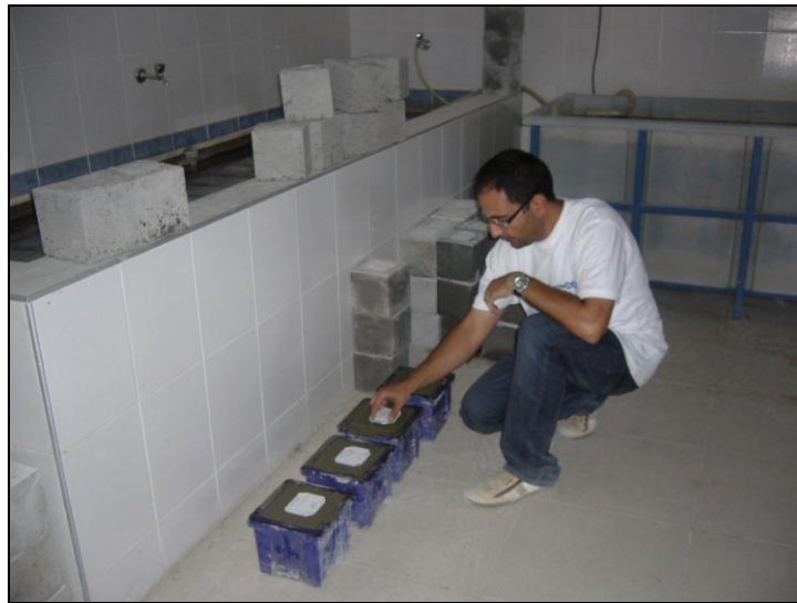
Şekil 2.6. Küp kalıplara yerleştirilen betonun etiketlenmesi görünüşü
