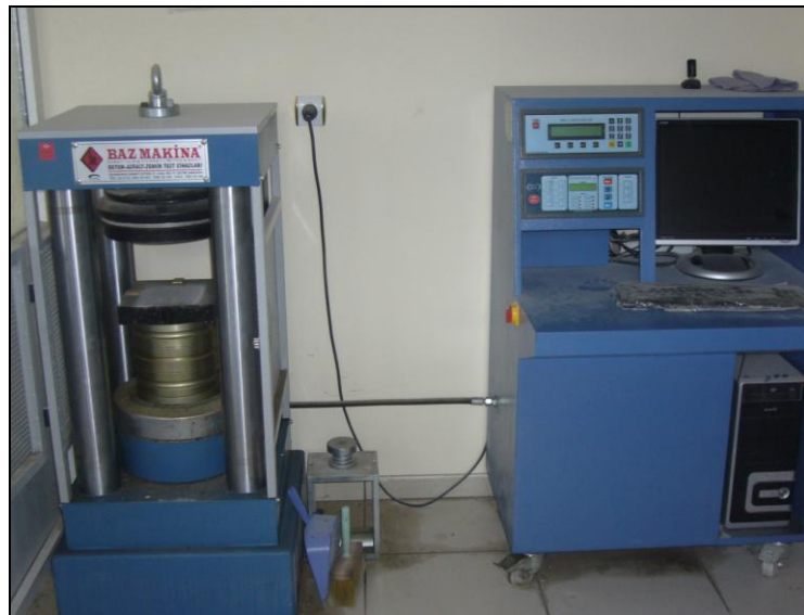
Şekil 3.9. Beton kırımı için pres ölçüm makinesi
