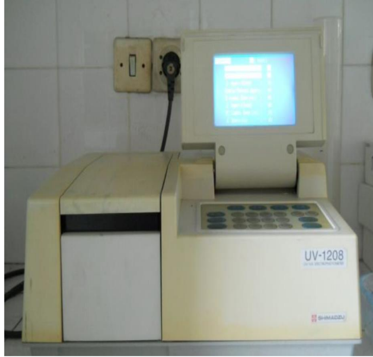
Şekil 2.6. Kimyasal analizlerinin yapıldığı Shimadzu UV 1208 cihazı
