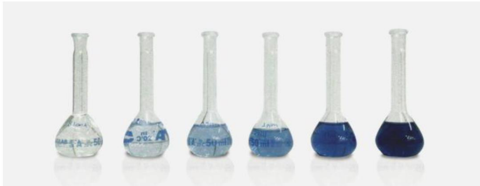
Şekil 2.7. Çeşitli konsantrasyonlarda arsenik içeren çözeltinin analiz çözeltisine verdiği renk tepkisi
