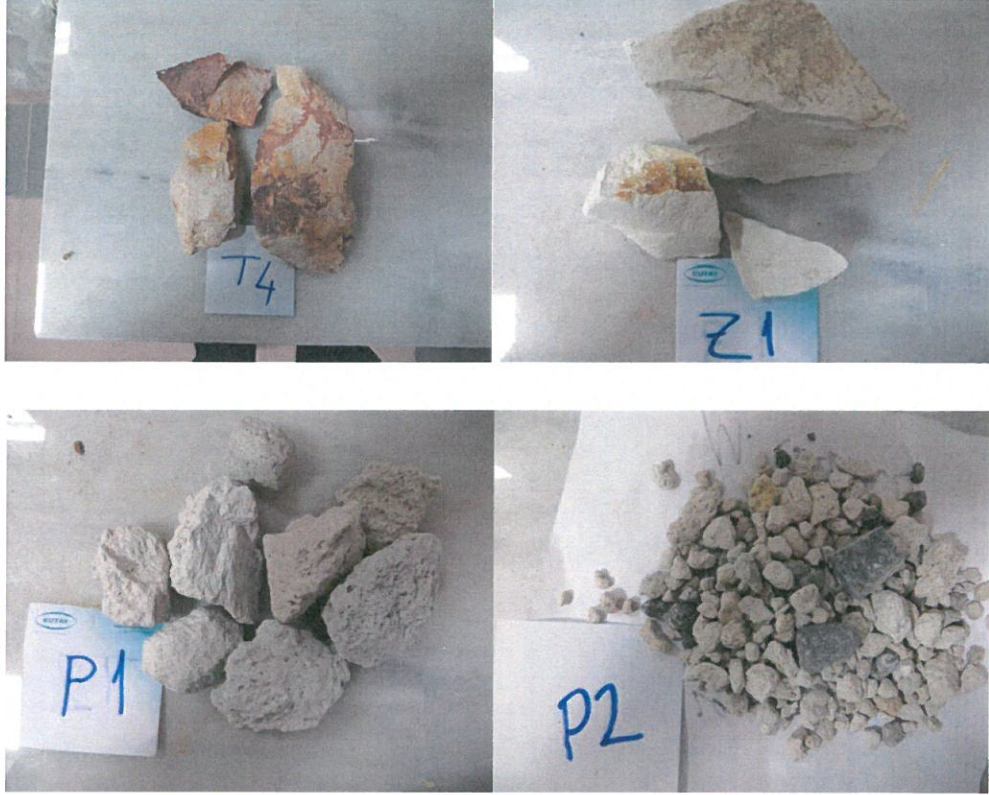
Şekil 2.1. Araziden örnekleme yapılmış bazı doğal puzolanlardan görünüm
