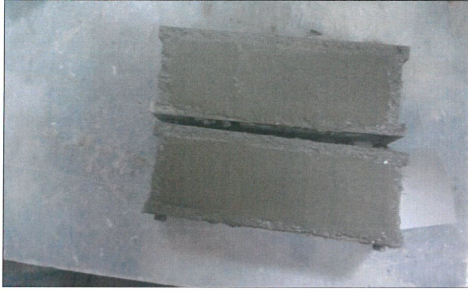
Şekil 2.3. Küp numunelerin kalıplara dökülme işleminden görünüm
