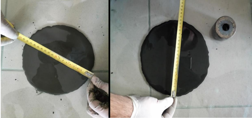
Fotoğraf 4.5. Mini slump testi
