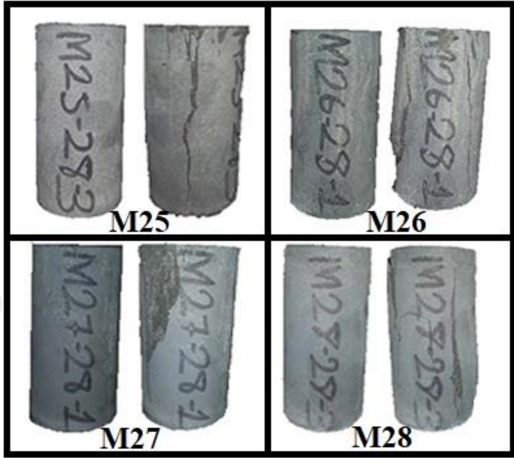
Fotoğraf 5.13. M125-M28 kırılma şekilleri
