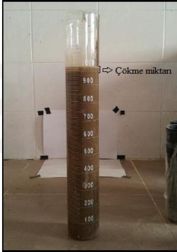
Şekil 1.10. Bleeding (çökme) deneyi(Çelik, 2016)
