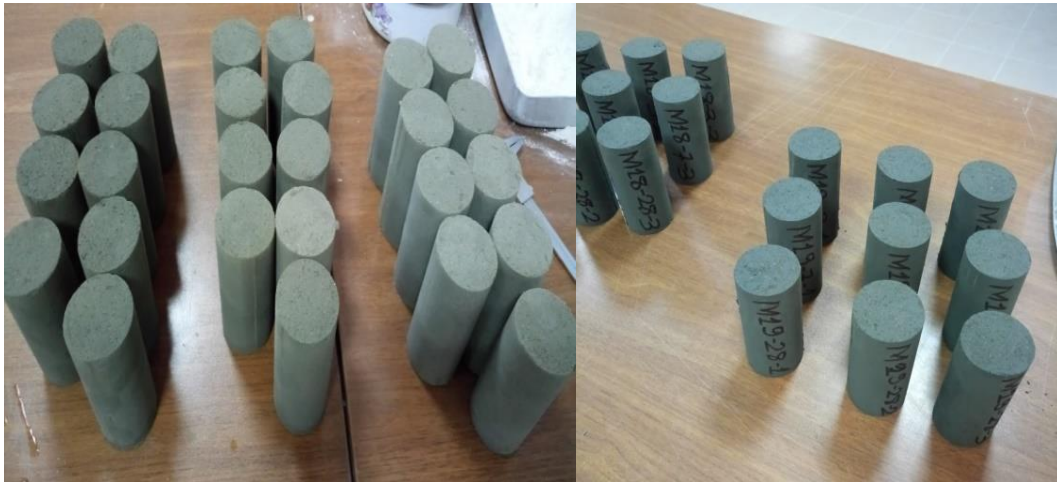
Fotoğraf 5.5. Kalıplardan çıkartılıp traşlanan soilcrete numuneler
