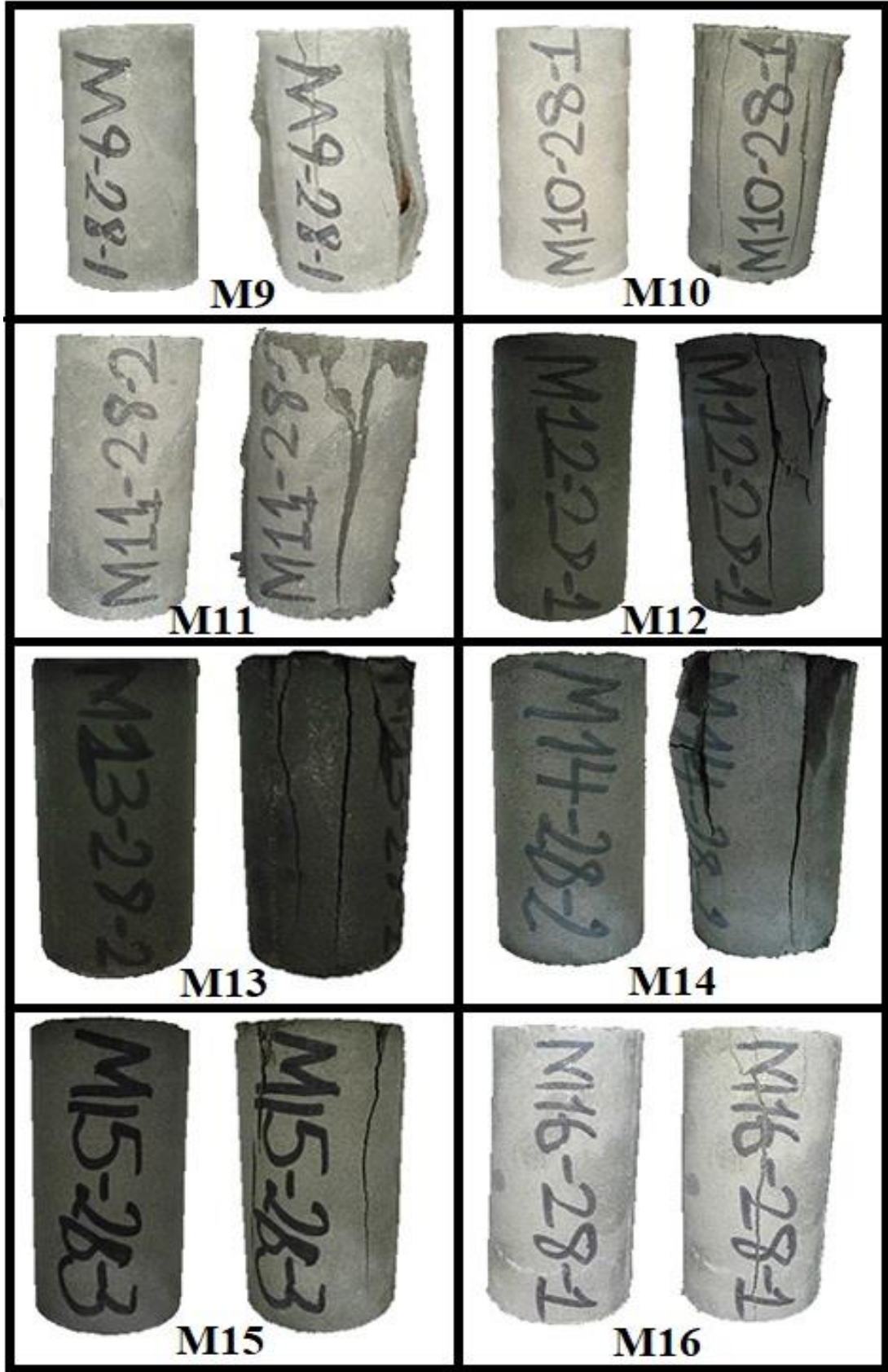
Fotoğraf 5.11. M9-M16 kırılma şekilleri
