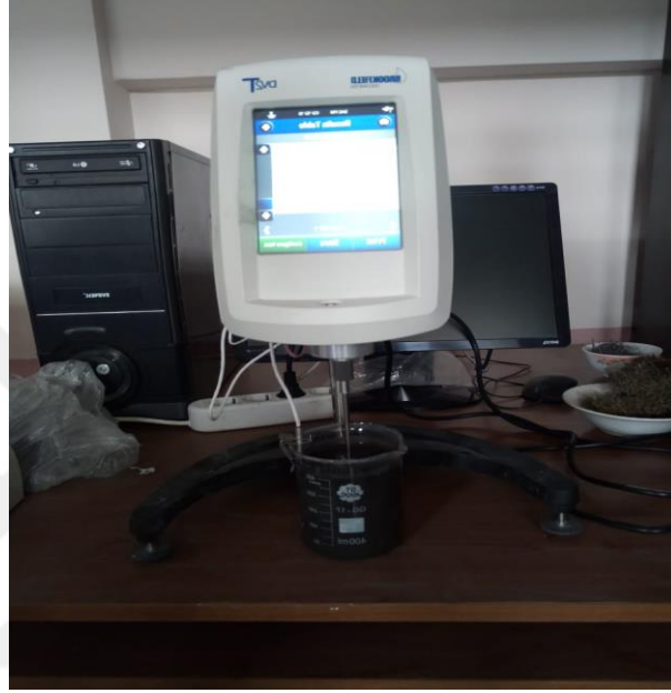
Fotoğraf 4.2. Koaksiyel Döner Silindir Reometresi (Brookfield Viskozimetre DV2T)
