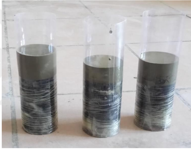
Fotoğraf 5.4. Kalıplara dökülen soilcrete numuneler
