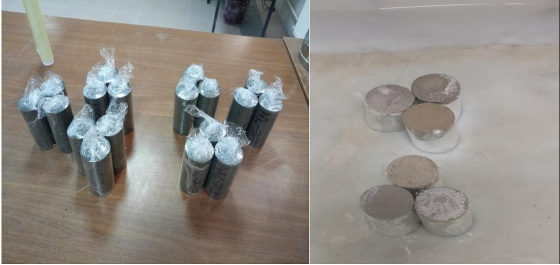
Fotoğraf 5.6. Numunelerin streç ile sarılıp su içinde küre bırakılması
