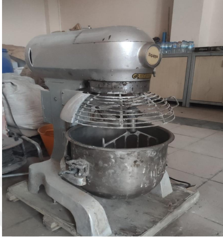
Fotoğraf 5.2. Kullanılan standart döner tip 10 litre laboratuvar mikseri
