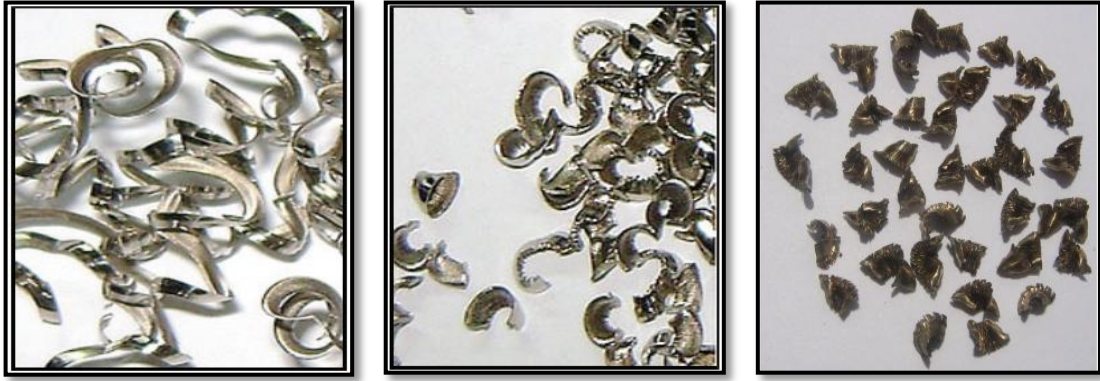
Fotoğraf 4.2. Değişik kesme ve ilerleme miktarlarında çıkan talaşlar (Taşdemir, 2006)
