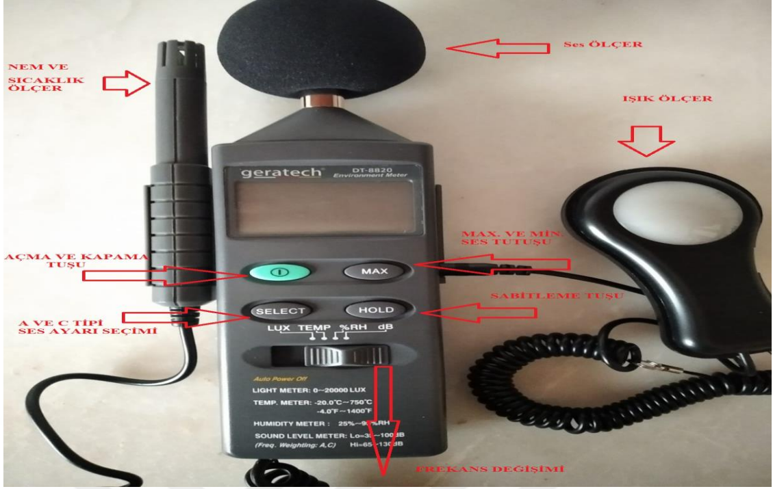
Fotoğraf 7.1. Geratech DT-8820 ses ölçüm cihazı
